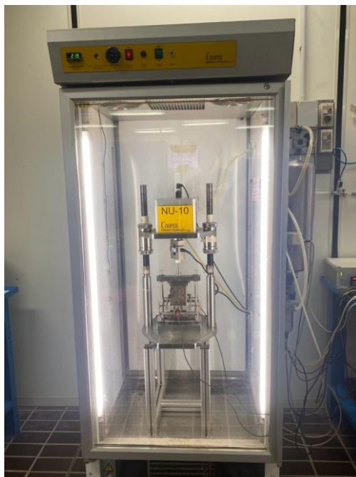
Fig. 3.28 - Provino posizionato nel NAT
