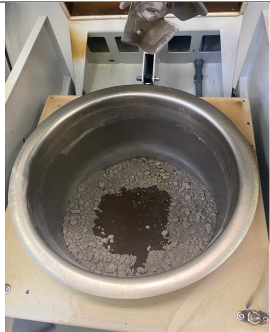
Fig. 3.11 – Aggiunta di emulsione
