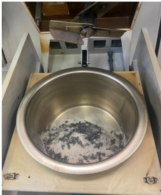
Fig. 3.7 – aggiunta di fibra tessile proveniente da PFU
