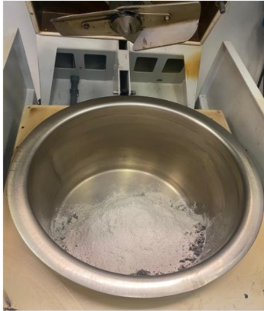
Fig. 3.6 – Aggiunta di filler di recupero
