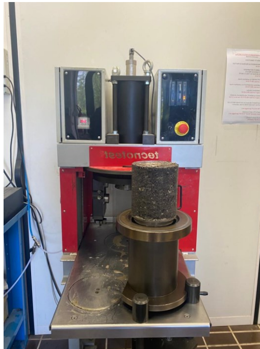
Fig. 3.20 – esempio di estrazione provini
