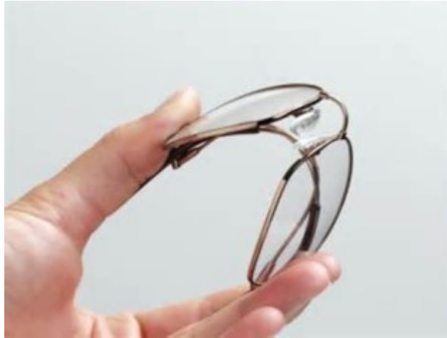
Figura 2 – Manifestazione dell'effetto superelastico in un paio di occhiali realizzati in lega SMA.
