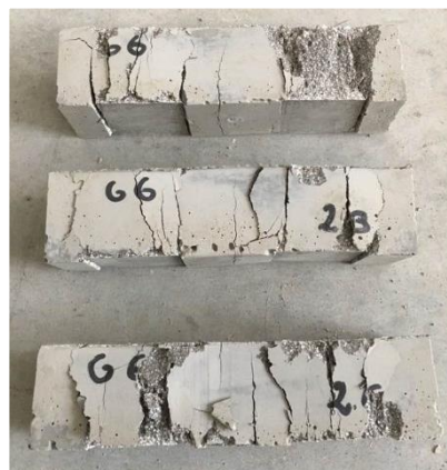
Figura 32-Setup di prova a compressione “ 4 \times 4 \times 16 \text{ cm}^3 ”
