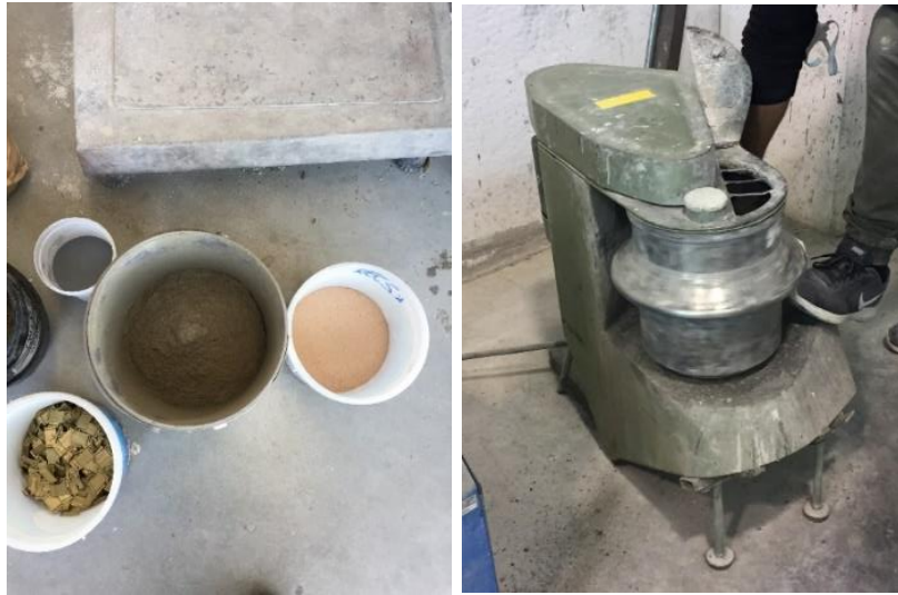
Figura 24-Pesatura componenti UHPC e successiva miscelazione
