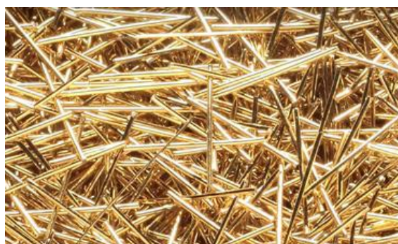
Figura 23-Fibra in acciaio rivestita di ottone
