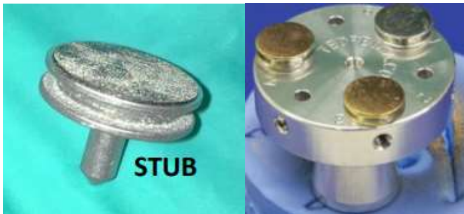
Figura 2.2.1 A sinistra uno stub e a destra un portacampioni
