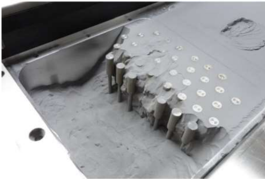
Figura 1.2.3.2 I pezzi prodotti con tecnologia LPBF sono immersi in una grande quantità di polvere non fusa
