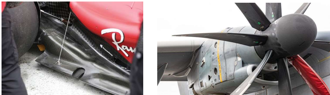
Figura 1.2: fibra di carbonio nel telaio di una monoposto di Formula 1 e all'interno di una struttura alare [7] [8].
