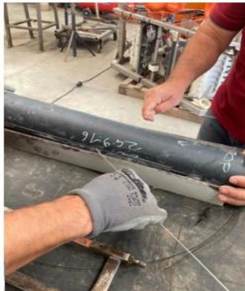
*Figura 29. Taglio longitudinale della carota con filo in nylon.*
