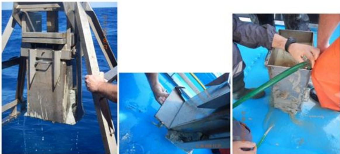
*Figura 23. Operazioni di recupero del box corer*
