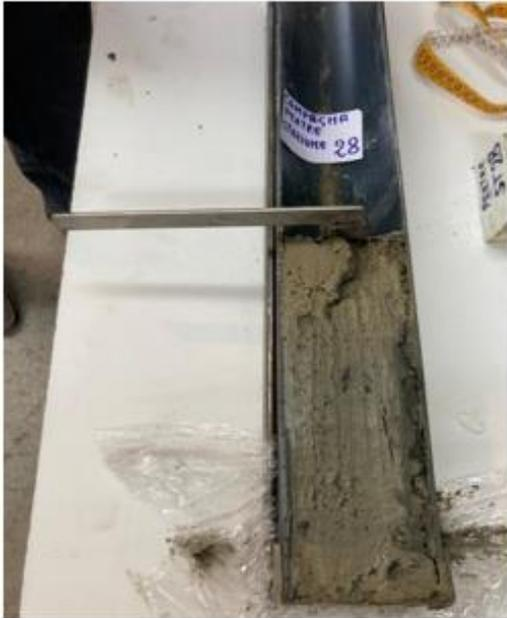
*Figura 34. Subcampionamento delle carote con spatola*
