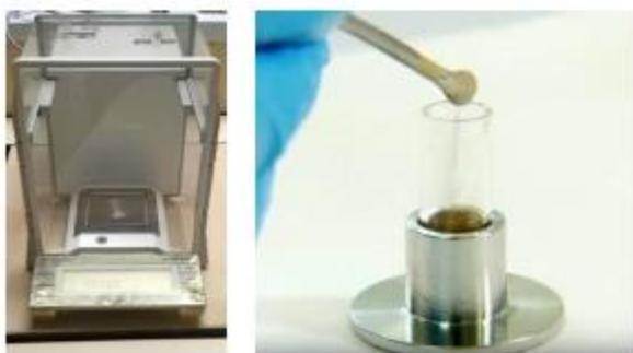
*Figura 39. Bilancia analitica Mettler Toledo AT 261 DeltaRange e dettaglio della pesata del campione di sedimento.*
