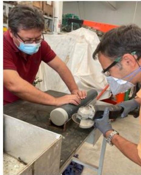
*Figura 28. Apertura longitudinale del liner mediante tagliatrice.*
