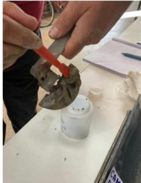
*Figura 35. Inserimento degli strati di campione nell'appropriato contenitore*
