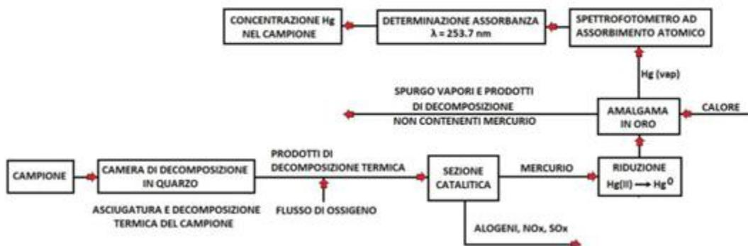
Figura 37. Schema di funzionamento dell'analizzatore elementare (metodo US-EPA 7473).
