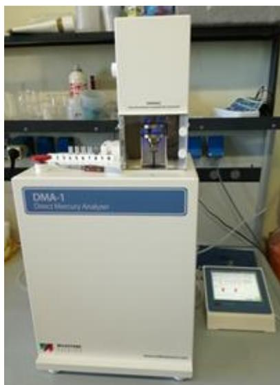
*Figura 36. Analizzatore Diretto di Mercurio.*
