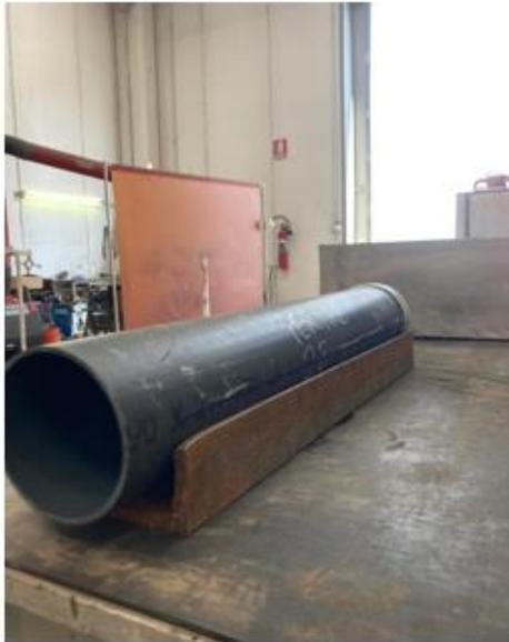
*Figura 27. Posizionamento della carota in liner di polietilene su supporto orizzontale.*
