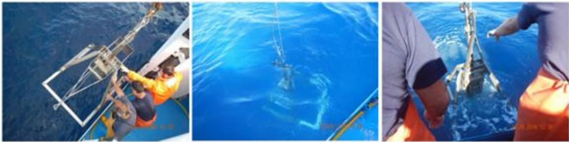
*Figura 22. Operazioni di messa a mare del box-corer*
