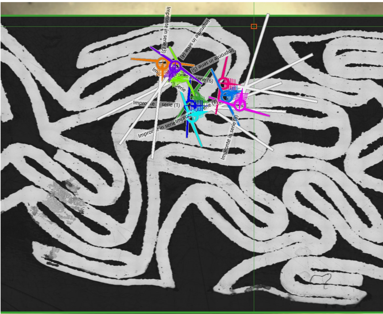
Figura 42: prova di microdurezza sul campione xy deformato dinamicamente solo sui nodi
