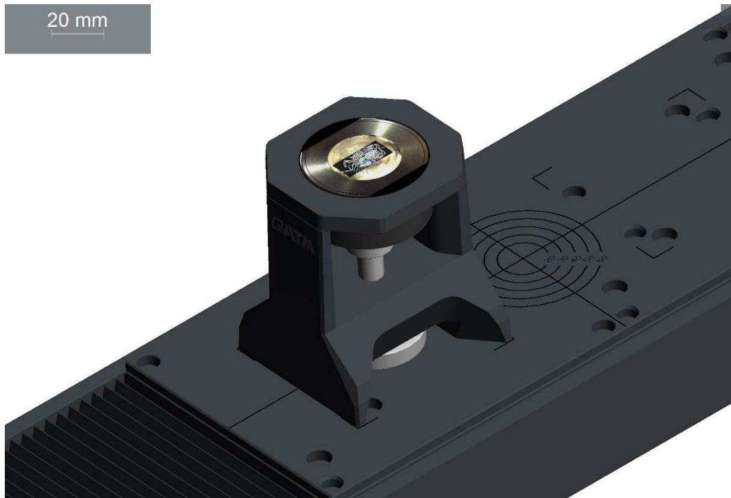
Figura 27: set-up prove di microdurezza sul campione xy deformato dinamicamente
