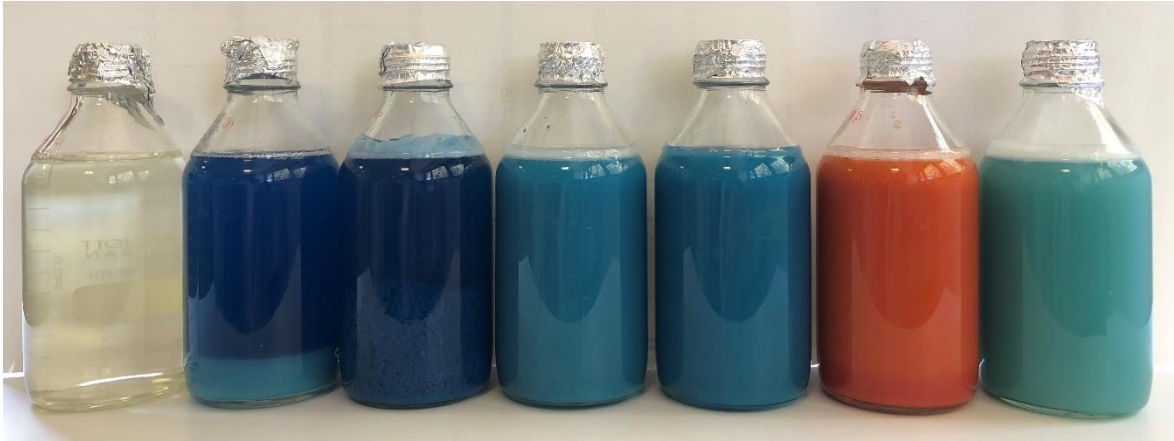
Figura 22 – Risultati della combinazione tra prodotti cuprici a dose piena e chitosano denso alla concentrazione dello 0,5% di principio attivo durante la prima prova di compatibilità in laboratorio. In ordine, da sinistra verso destra: chitosano 0,5%, combinato con idrossido di rame, solfato di rame neutralizzato, solfato di rame tribasico, ossicloruro di rame, ossido rameoso e solfato di rame tribasico più idrossido di rame.
