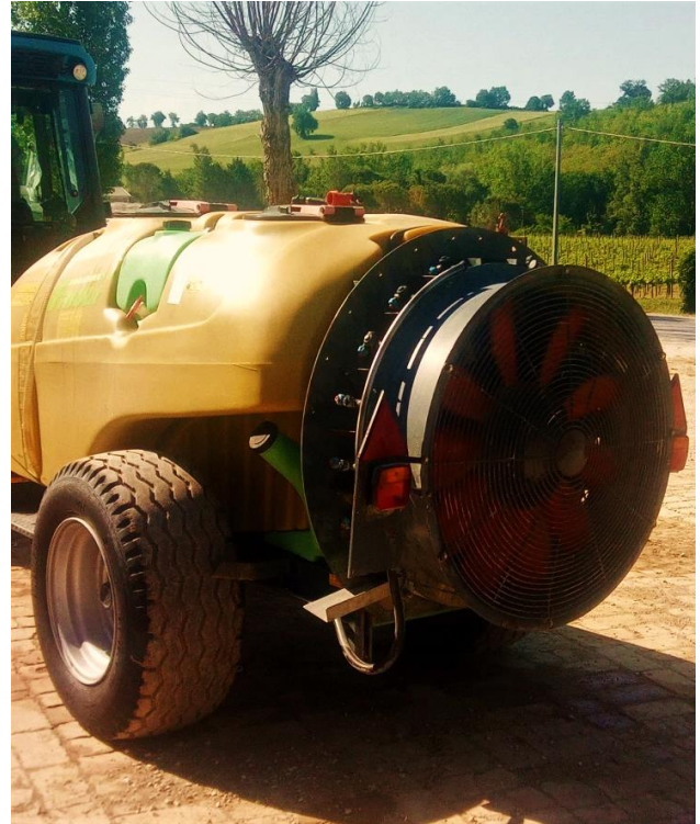
Figura 14 – Atomizzatore trainato della Società Agricolmeccanica, modello Poli 15 impiegato nei trattamenti effettuati nel vigneto di Matelica (MC).
