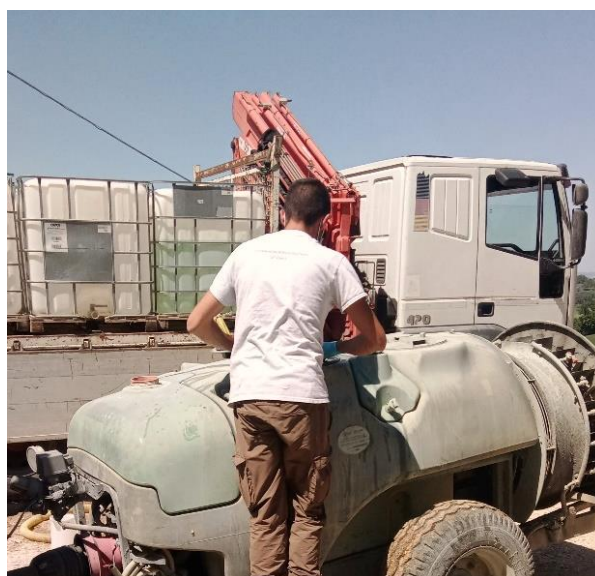
Figura 16 – Atomizzatore trainato della Società Agricola Estense, modello Turbmatic Defender MK2 utilizzato durante i trattamenti nel vigneto di Castelplanio (AN).
