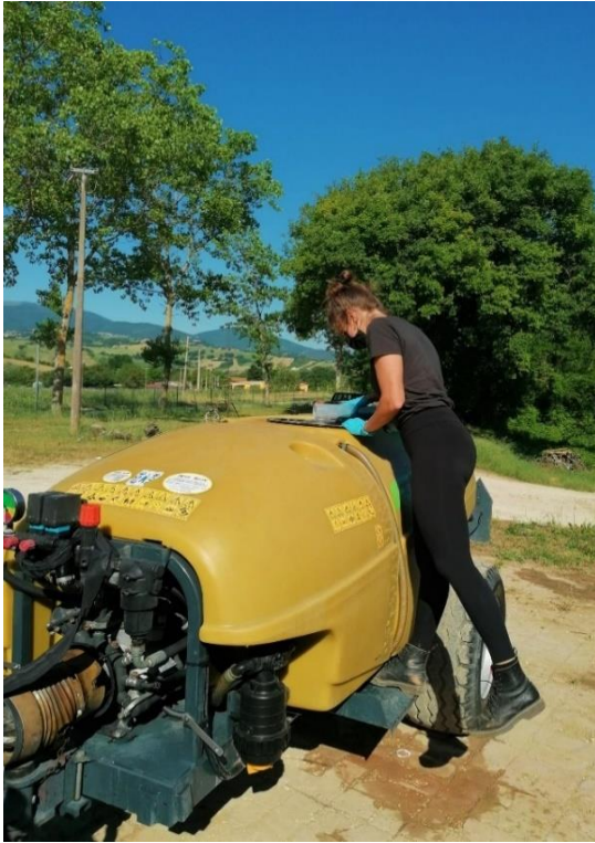
Figura 14 – Atomizzatore trainato della Società Agricolmeccanica, modello Poli 15 impiegato nei trattamenti effettuati nel vigneto di Matelica (MC).
