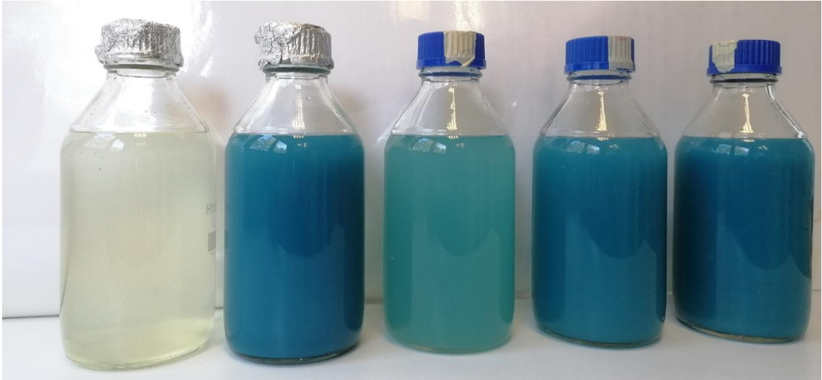
Figura 23 – Combinazioni di Chitosano denso 1% + ossicloruro di rame. Da sinistra verso destra: testimone chitosano 1%; testimone ossicloruro di rame DP; chitosano 1% + ossicloruro di rame \frac{1}{4} DP; chitosano 1% + ossicloruro di rame \frac{1}{2} DP e chitosano 1% + ossicloruro di rame DP. I due prodotti non hanno mostrato reazioni di incompatibilità in laboratorio, nelle varie concentrazioni o dosi saggiate.
