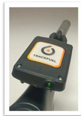
Fig. 2.6.b – ANTENNA ACCOPPIATA CON TAG RFID
