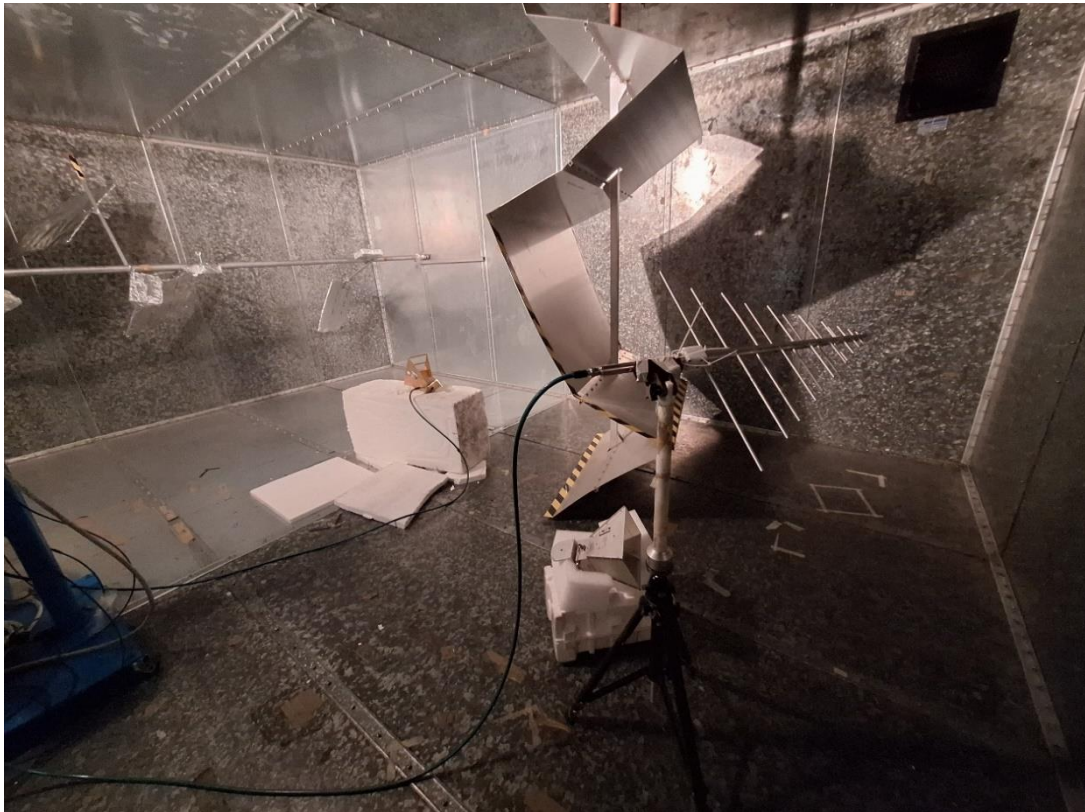
Figura 8: RC vuota con radiobase e antenne Log-periodiche e Double Ridge
