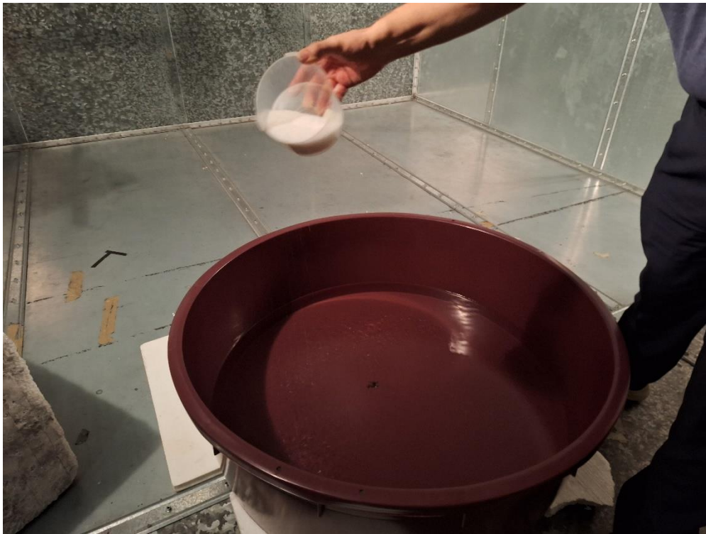
Figura 19: Inserimento del sale all'interno della mastella contenente acqua
