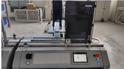
Figura 1.5.: Fotocamera 1 per ispezione qualità.
