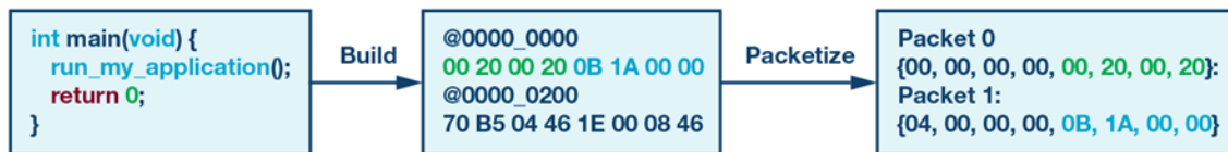
Figura 2.2: Processo di conversione binaria e di pacchettizzazione di un'applicazione software.
