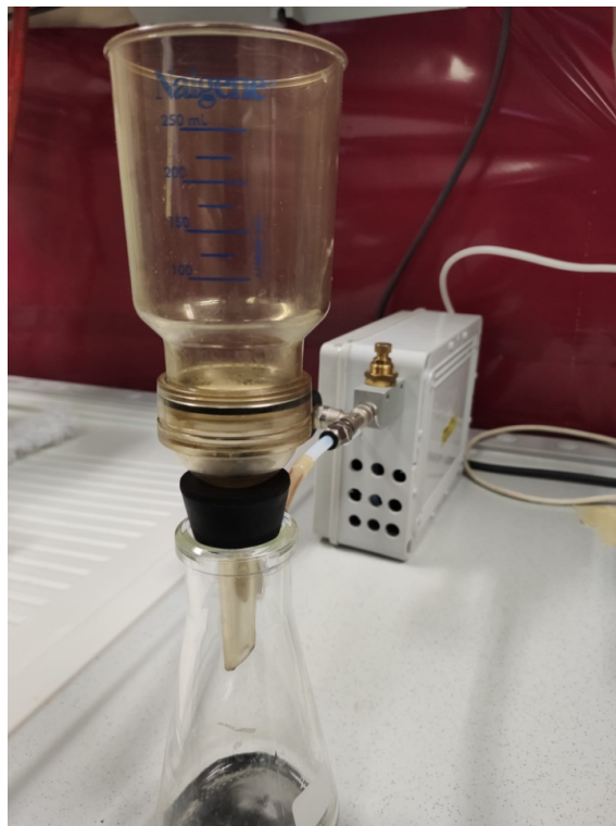
Figura 11: Foto sistema filtrante
