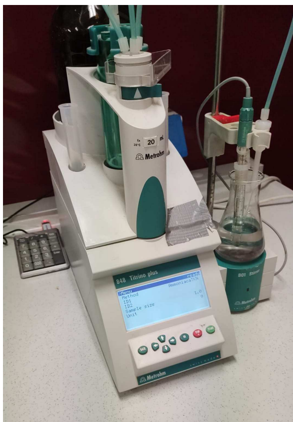
Figura 10 : Foto strumento “Titrino”
