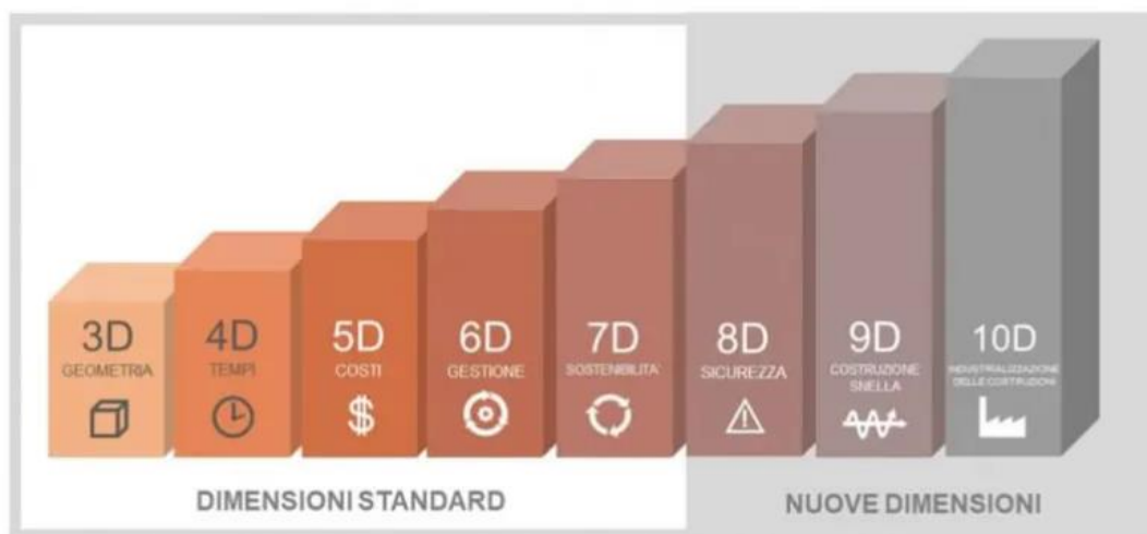
Figura 14 – Le 10 dimensioni del BIM
