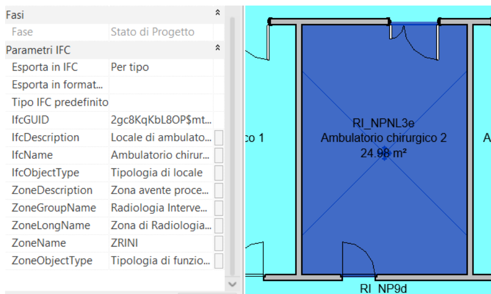
Figura 74 – Definizione dei parametri IFC ad ogni locale
