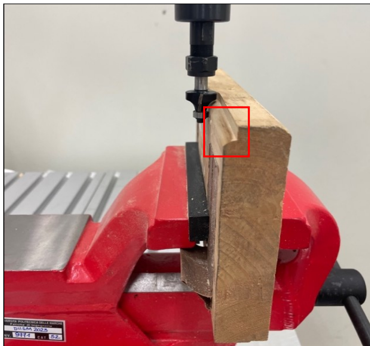
Figura 7.2. 7: Dettaglio della prova con velocità di avanzamento di 8 mm/s.
