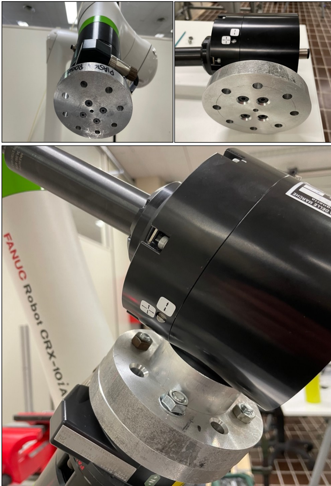
Figura 7.1. 5: Montaggio del primo elemento alla flangia del robot (in alto a sinistra), montaggio dell'elemento intermedio con distanziale al mandrino (in alto a destra) e montaggio completo (in basso).
