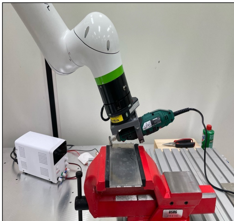
Figura 5.1. 3: Operazione di lucidatura effettuata dal robot con l'utensile installato.
