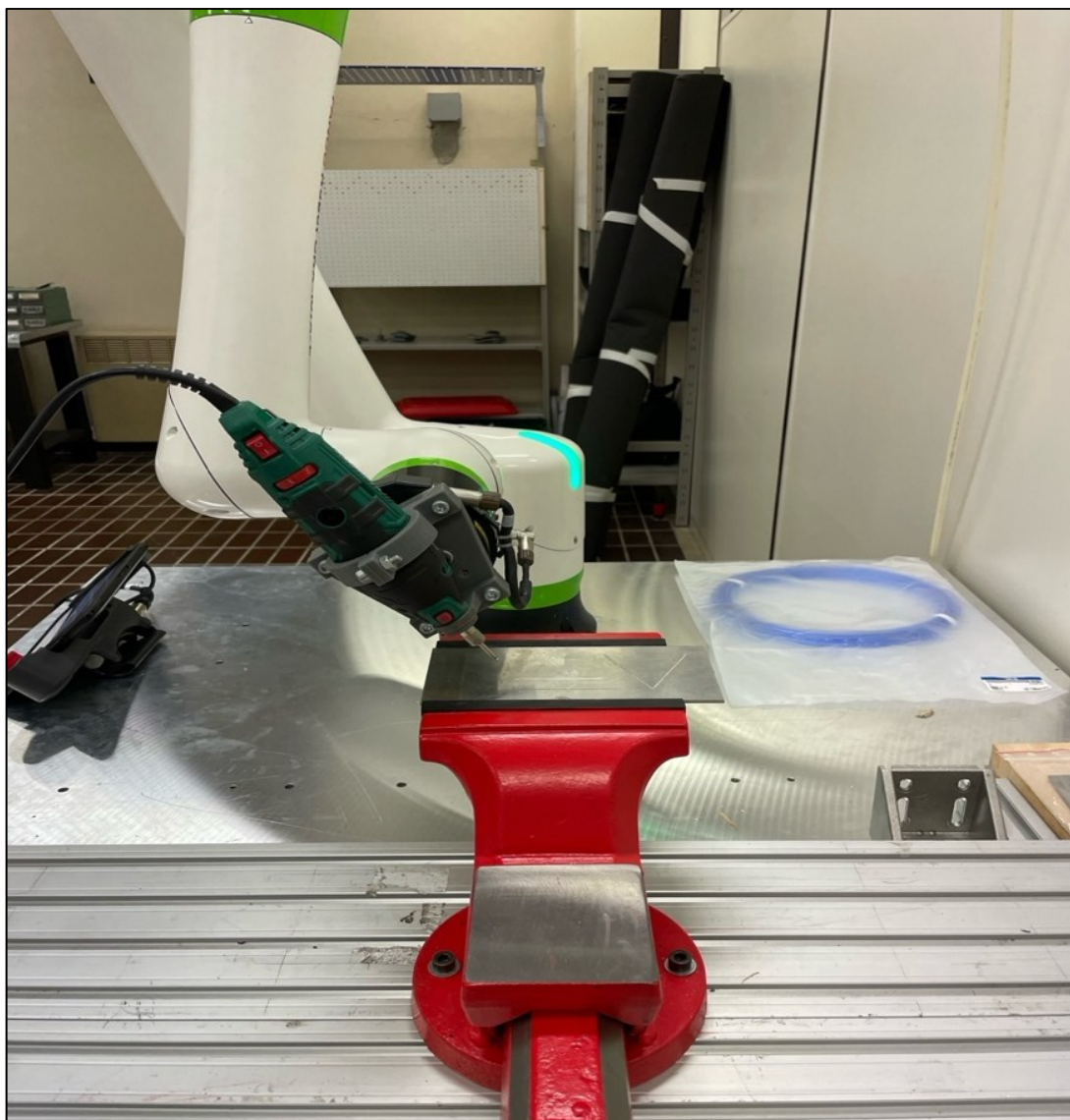
Figura 6. 1: Operazione di incisione su piastra in alluminio.
