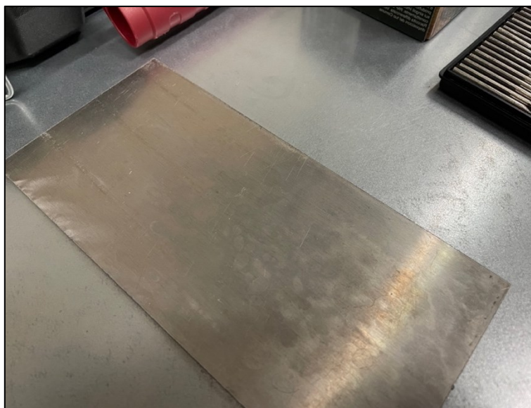
Figura 4.1.1. 1: Piastra di alluminio di dimensione 18 x 8.5 x 0.3 cm.
