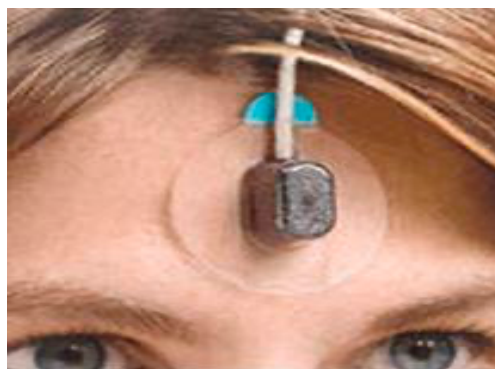
Figura 3.4 Pulsossimetro a riflessione
