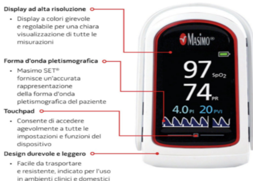
Figura 4.2 MightySat Rx pulsossimetro
