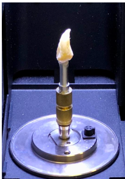
Fig. 11. Campione posizionato sul supporto interno della \mu -CT.
