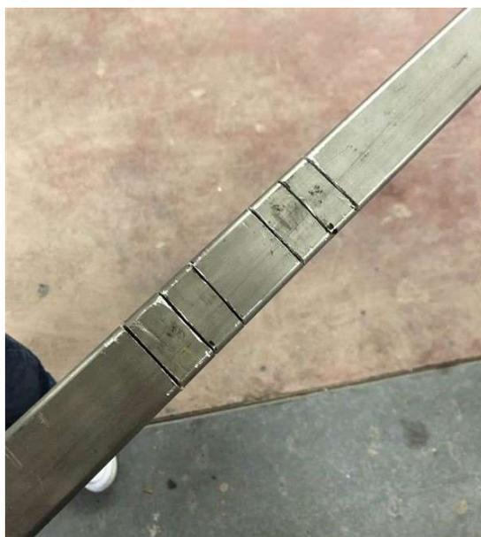
Figura 5.12 (a) Vista dell'alto del grado di danno D3 della trave.
