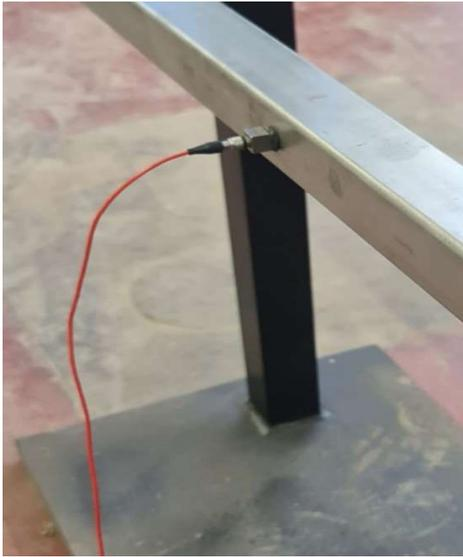
Figura 4.5 Accelerometro 4508 usato per raccogliere i dati di frequenza della trave.
