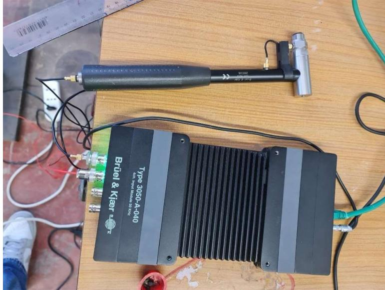
Figura 4.3 Modulo di acquisizione dati Brüel & Kjær Pulse, Type 3050-A-040; Impact Hammer 8202+2646.
