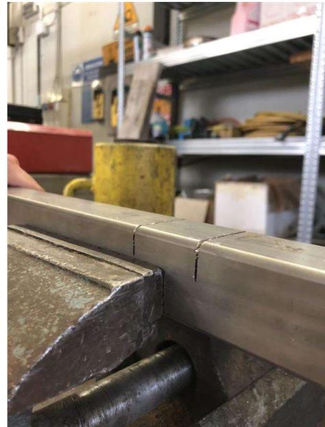
Figura 5.8 (b) Vista laterale del danno D1 della trave.
