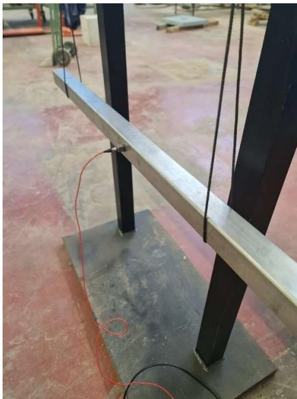
Figura 5.7 Esecuzione dell'analisi dinamica della trave rispetto la sua faccia laterale.
