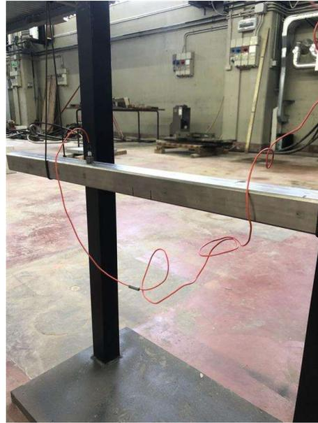
Successivamente abbiamo danneggiato nuovamente la trave, in condizioni D2, riproducendo i tagli delle stesse dimensioni ma collocate entrambe a 20 mm di distanza dai primi due tagli iniziali della trave D1. (Figura 5.11 a-b)
