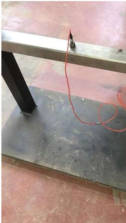
Figura 5.10 (a) Posizione dell'accelerometro nel punto 1 con la trave danneggiata allo stadio D1.
