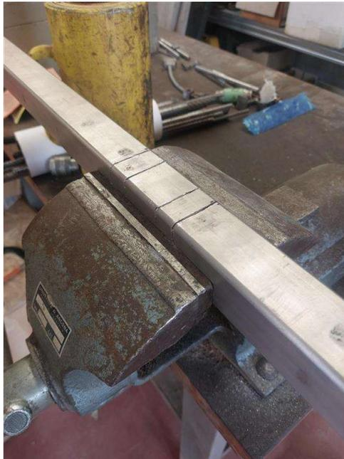
Figura 5.11 (a) Vista dall'alto del danno D2 della trave.
