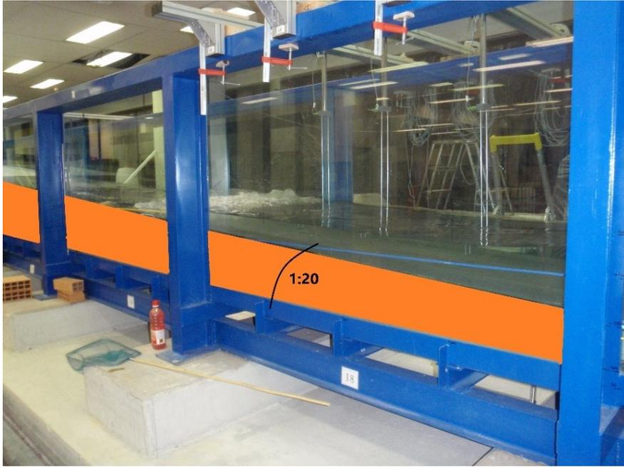
**Figura 3.5.1 – Rappresentazione del paramento inclinato 1:20**
