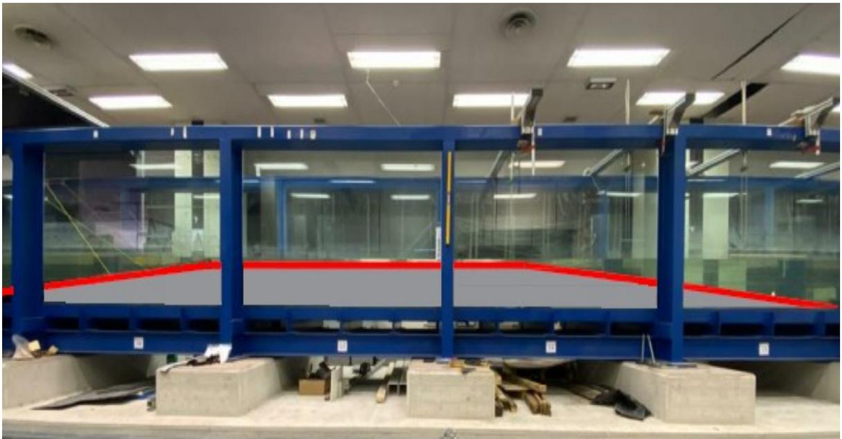
**Figura 3.6.3 – Configurazione della barra sommersa**
