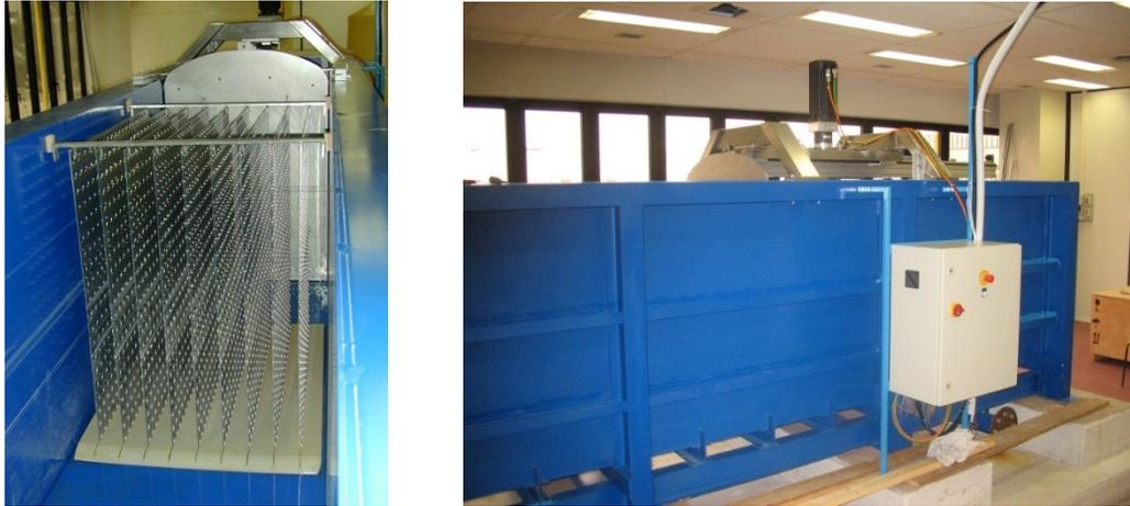
Figura 3.3.1 – *Generatore d'onda e sistema di controllo*
