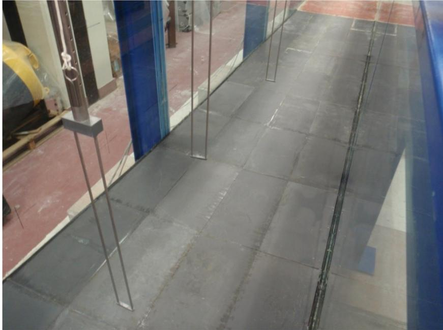
Figura 3.4.1 – Posizione delle sonde elettro-resistive di livello
