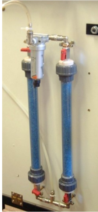
Fig. 2.12 – Deumidificatori carichi di Silicagel
