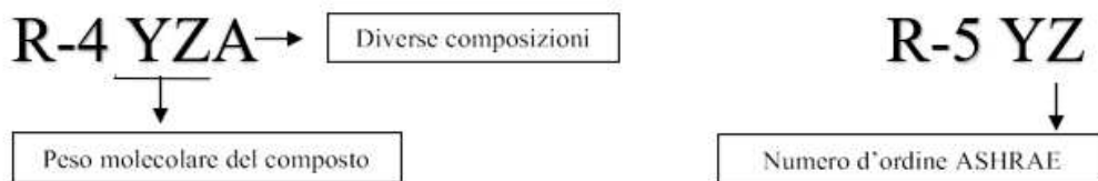
Fig. 1.3 – Nomenclatura miscele zeotropiche e azeotropiche
