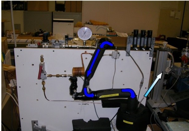
Fig. 2.6 – Modalità di funzionamento in raffreddamento
