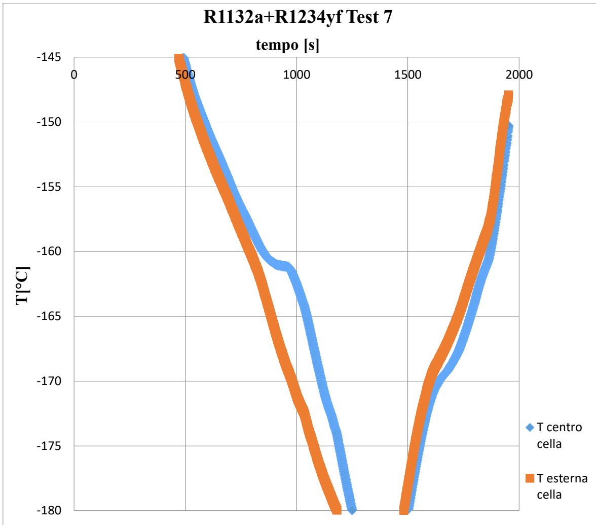
Fig. 3.9 - Grafico dell'andamento della temperatura che definisce il cambio di fase della miscela
