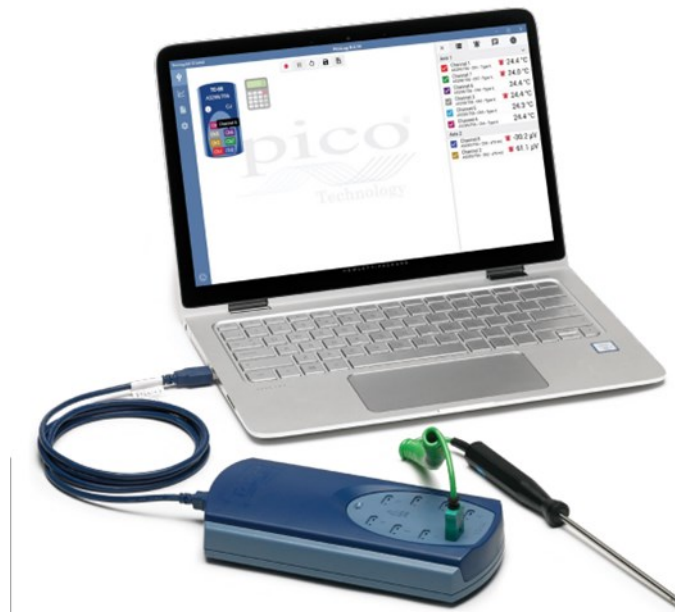
Fig. 2.17 – Connessione USB al pc e schermata software
