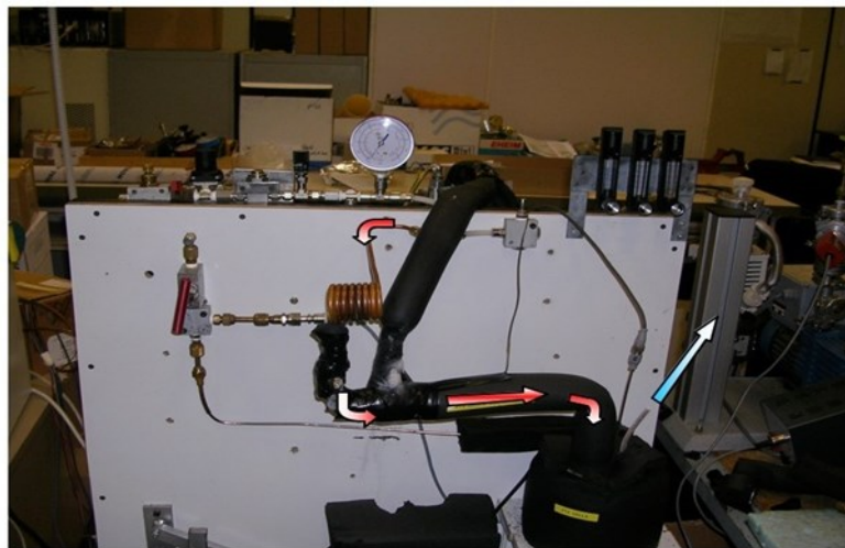
Fig. 2.9 – Modalità di funzionamento in riscaldamento
