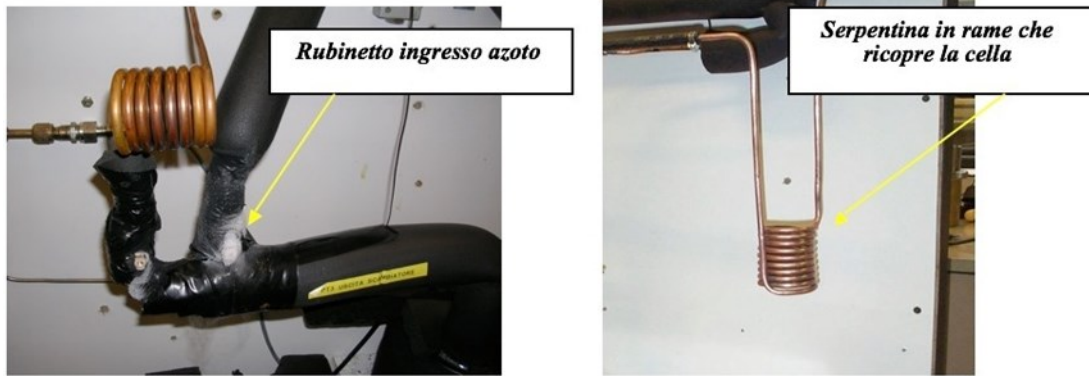
Fig. 2.3 – Ingresso azoto e serpentina di rame
