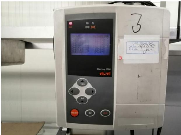
Fig.21 Display con rilevazioni delle sonde termometriche.
