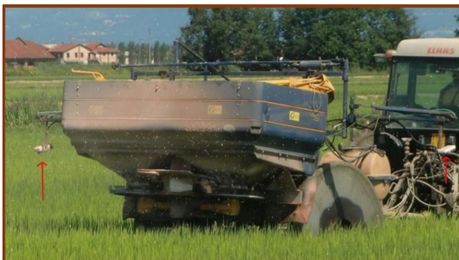
Figura 11. Spandiconcime a rateo variabile che effettua la distribuzione del fertilizzante azotato sul riso in maniera sito specifica, grazie all'utilizzo di due sensori prossimali (frecce rosse) che rilevano in continuo lo stato fisiologico della coltura sfruttando la riflettanza.
