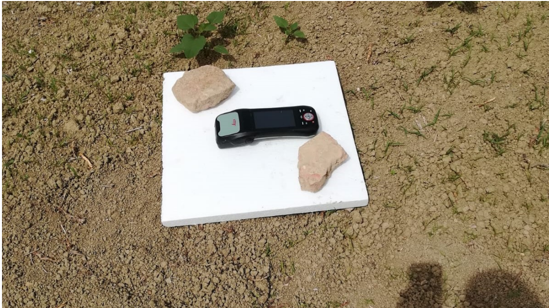
Figura 23. Georeferenziazione dei Ground Control Points (marker) identificati mediante pannelli di polistirolo bianchi.
