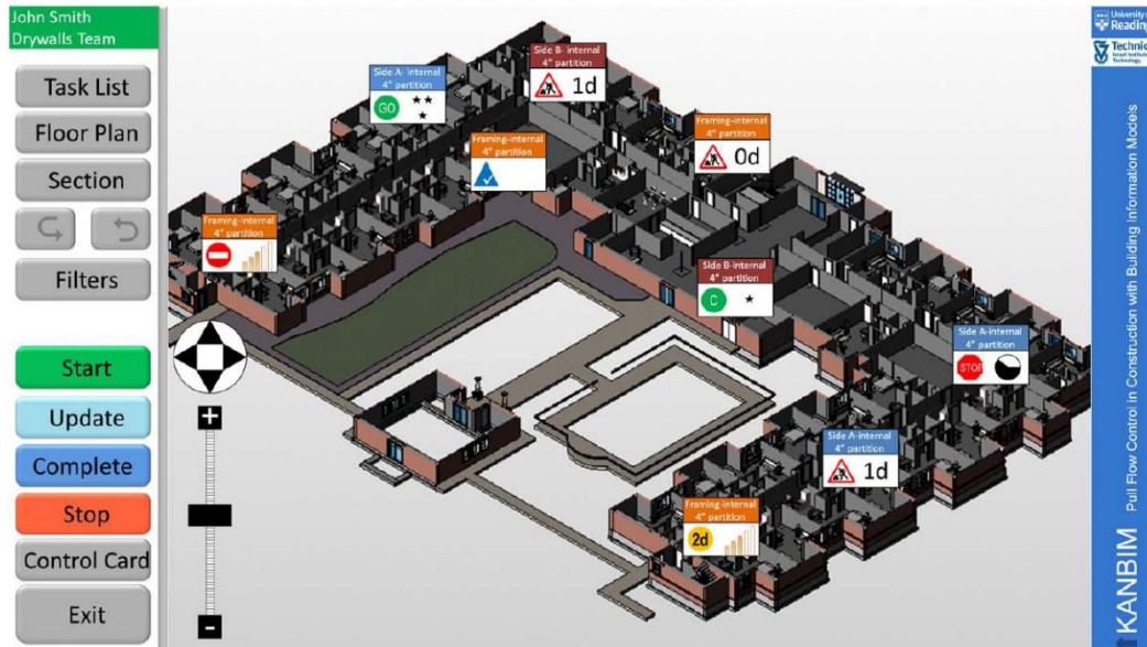
Figura 15 Più informazioni definiscono lo stato reale di avanzamento del flusso di produzione
