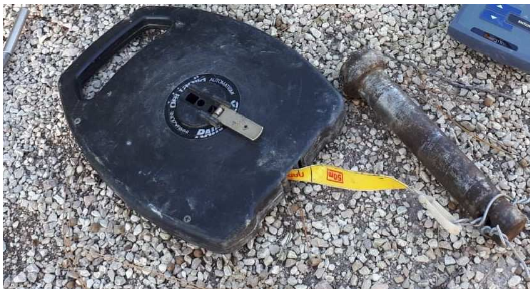
Fig. 2-23: Rullina metrica, per la misura del livello reale dell'acqua di pozzi e cisterne.
