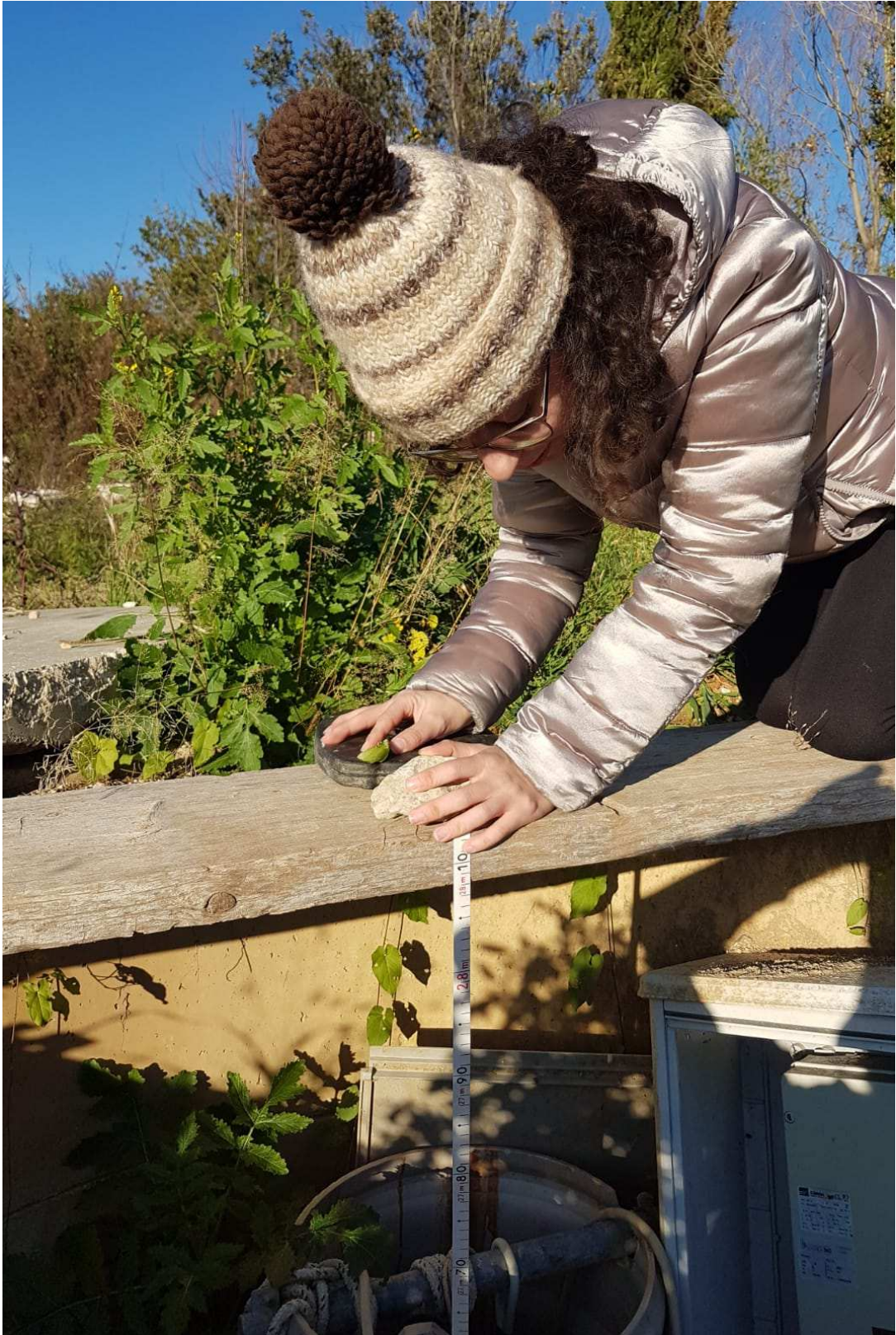
Fig. 5-10: Misura della profondità totale del terzo pozzo (P7), a ovest della Fonte di Butinello, mediante rullina metrica.
