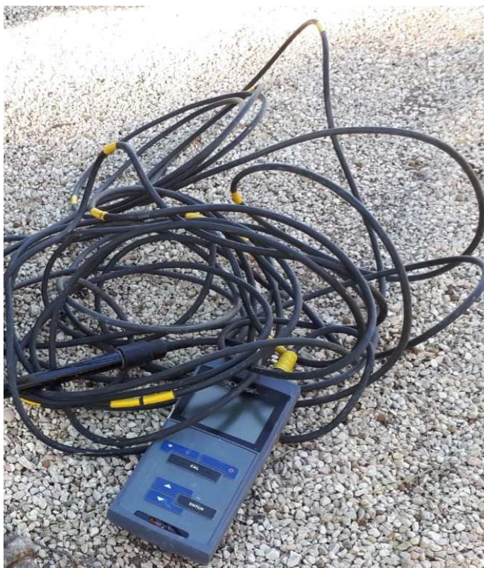
Fig. 2-21: Conducimetro, per la misura della conducibilità elettrica e temperatura dell'acqua.
