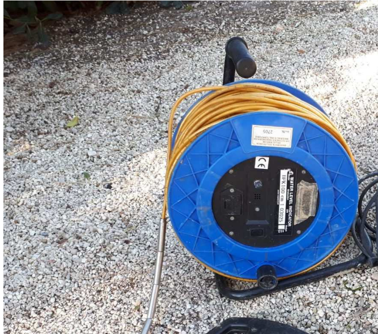
Fig. 2-22: Freatimetro, per la misura della profondità della superficie dell'acqua rispetto alla testa del pozzo.
