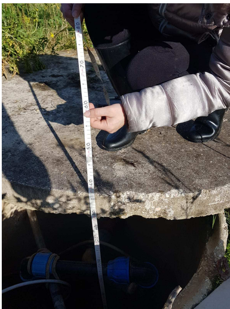
Fig. 5-9: Misura della profondità totale del secondo pozzo (P6), a ovest della Fonte di Butinello, mediante rullina metrica.
