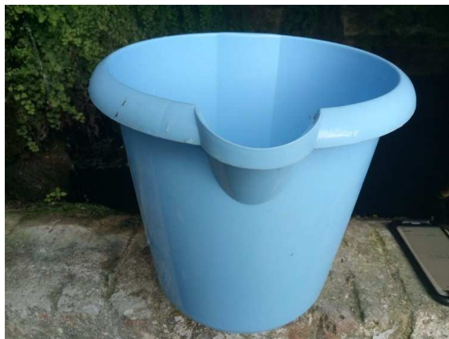
Fig. 2-25: Secchiello graduato, per la misura della portata effettiva della Fonte di Butinello.
