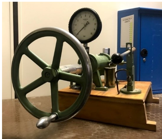
Figura 3.2: Macchina idraulica per taratura
