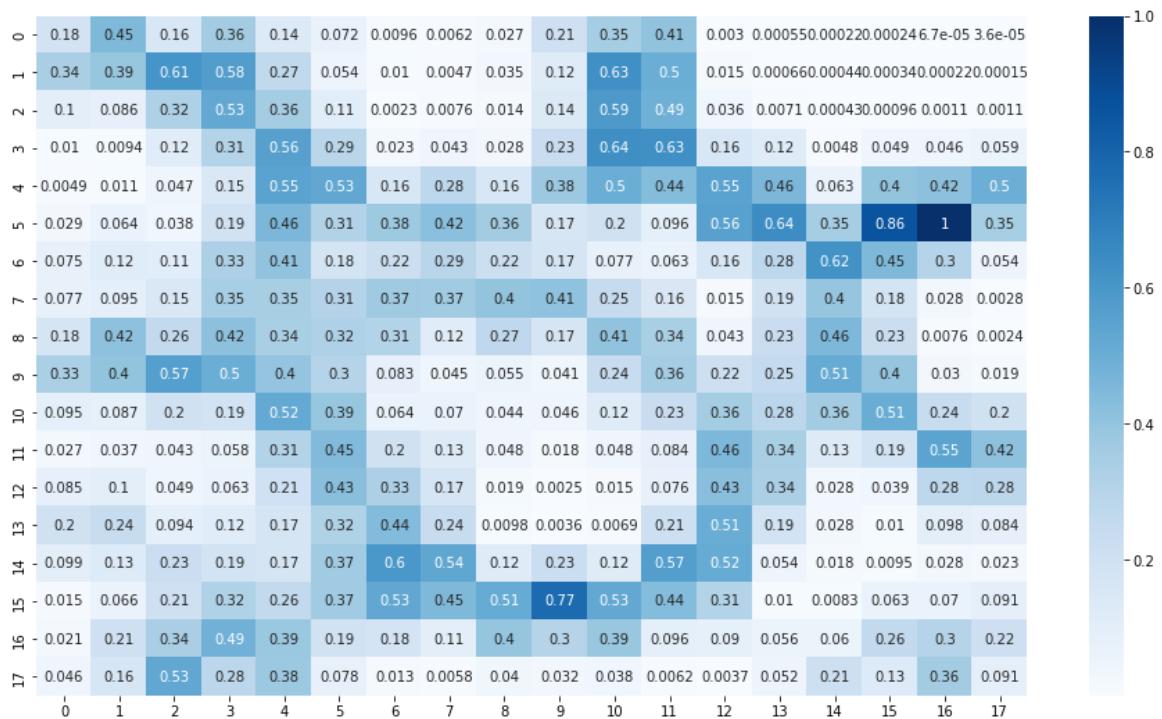
Figura 5.12: Rappresentazione della U-Matrix tramite mappa di colore
