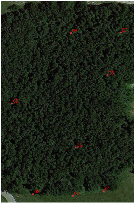
Fig. 6 – Punti registrati con ricevitore GNSS. I punti 1, 2, 3 sono al di fuori del bosco.
