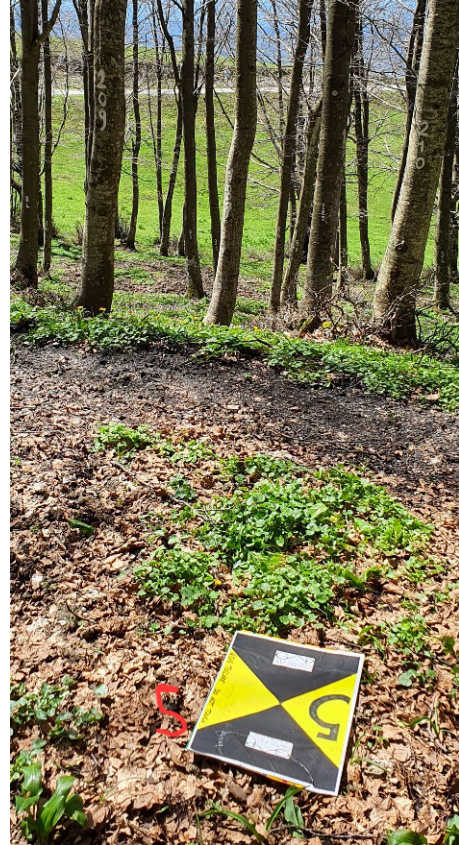
Fig. 7 – Uno dei target utilizzati per registrare i punti GNSS e GeoSLAM.
