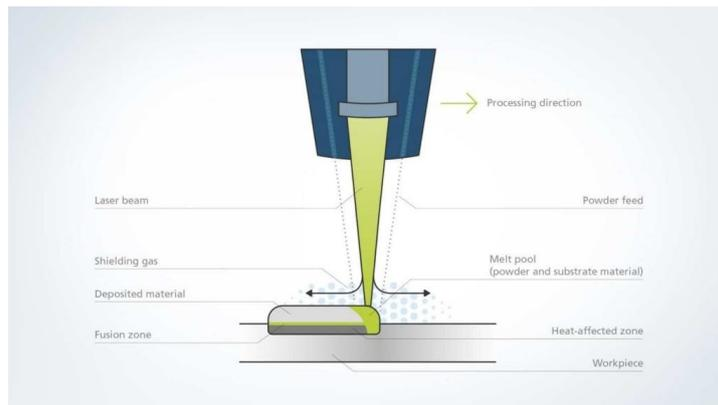
Figura 1.4. schema del processo a deposizione diretta
