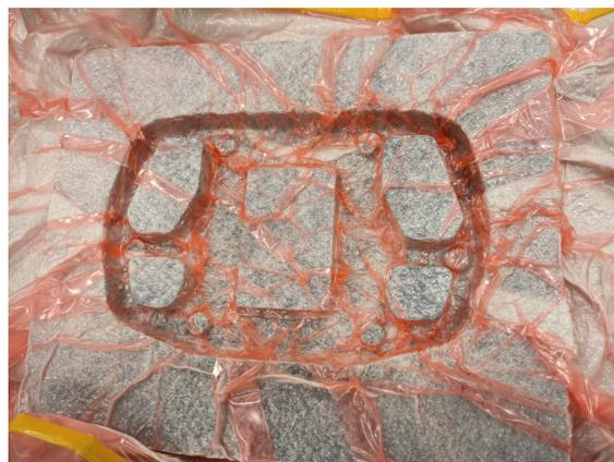
Figura 1.16. esempio di volante a gusci per una vettura di formula SAE in sacco
