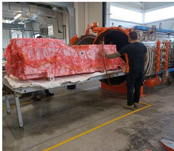
Figura 1.14. ciclo di cura in autoclave di un telaio in monoscocca per la formula SAE
