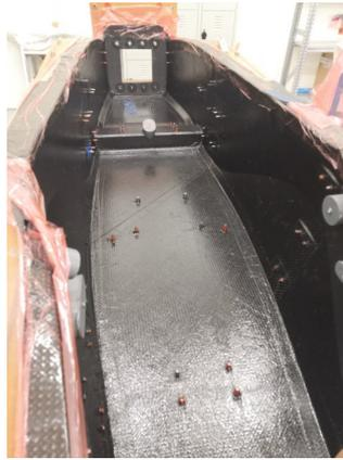
Figura 1.15. esempio di stratificazione di un telaio in monoscocca per la formula SAE
