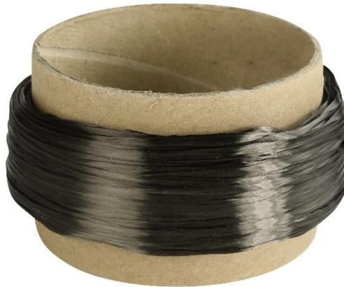
**Figura 2.1. bobina fibra di carbonio 6K**
