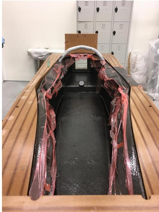
**Figura 1.8.** esempio di applicazione di materiale composito in un telaio per una vettura di formula SAE
