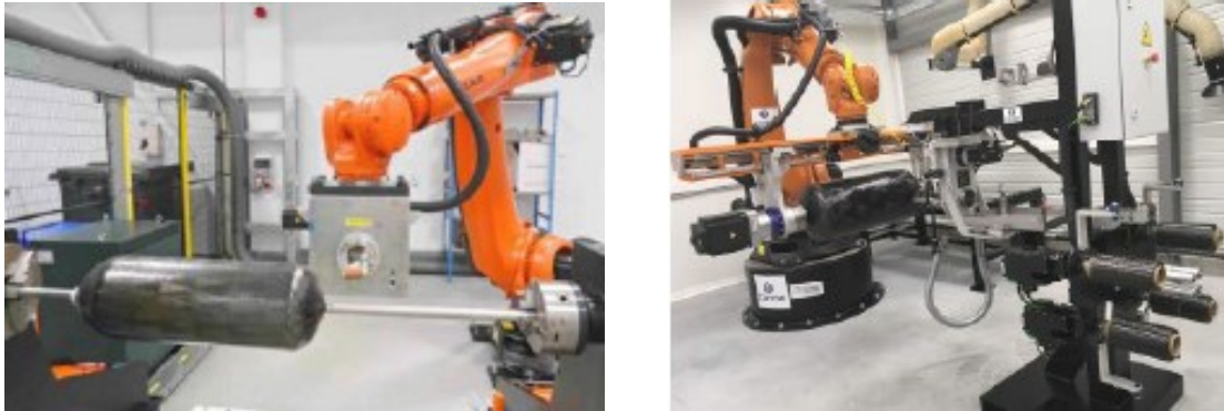
Fig. 4.6 Esempi di applicazioni di Filament Winding Robotizzato
