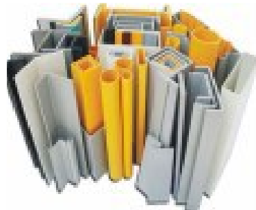
Fig. 4.14 Esempi di sezioni ottenibili con il processo di Pultrusione
