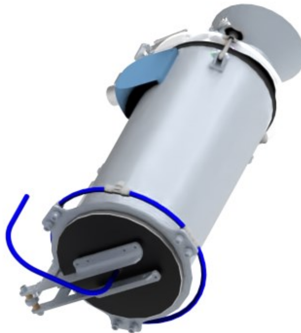
Fig. 7.34 Rendering della spellicolatrice pneumatica in cui si può notare l'anello chiuso di alimentazione degli ugelli tangenziali e il ramo di alimentazione dell'ogiva
