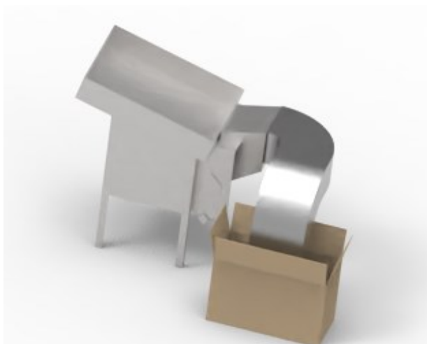
Fig. 7.36 Rendering della zona di defogliazione dove si nota il convogliatore delle pellicole
