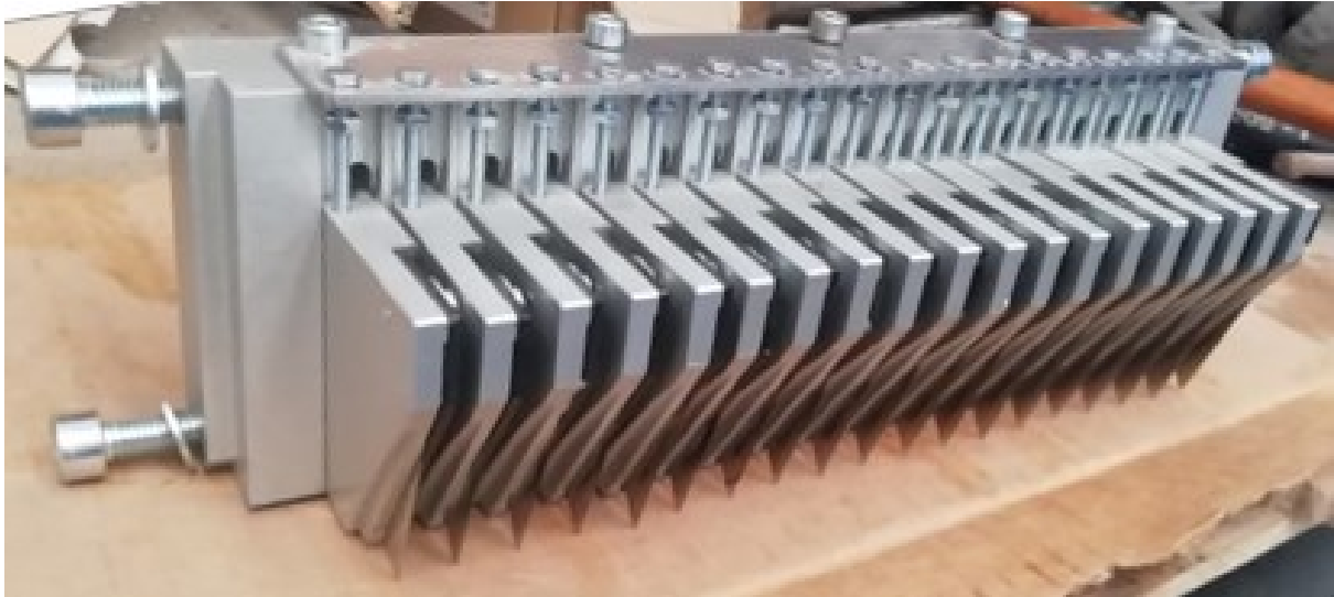
Fig. 6.6 Blocco lame 12 mm rettificato
