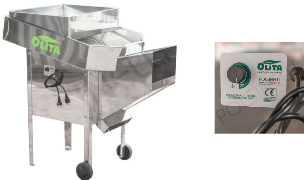
Fig. 6.19 Macchina defogliatrice Olita AOP0157 con regolatore di velocità
