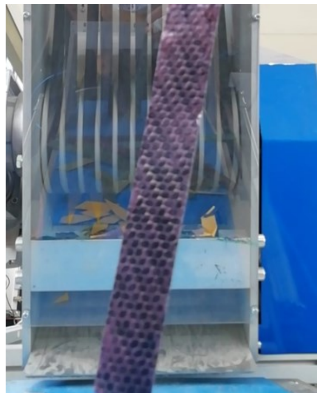
Fig. 6.7 Focus sul blocco lame, dove si può notare l'intersezione tra lama e rullo (a sinistra), chips completamente distaccata uscente dalla taglierina dopo la modifica del blocco lame (a destra)
