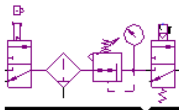
Fig. 7.4 Simbolo gruppo FRL composto da valvola lucchettabile, filtro con scarico manuale, filtro riduttore integrato con elettrovalvola
