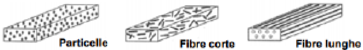
Fig. 1.13 Tipologie di rinforzi
