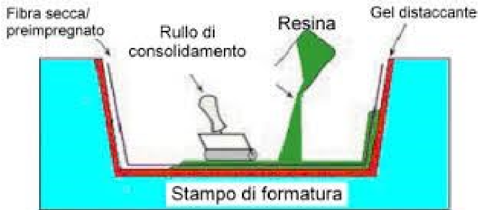
Fig. 4.1 Schema di processo di laminazione manuale
