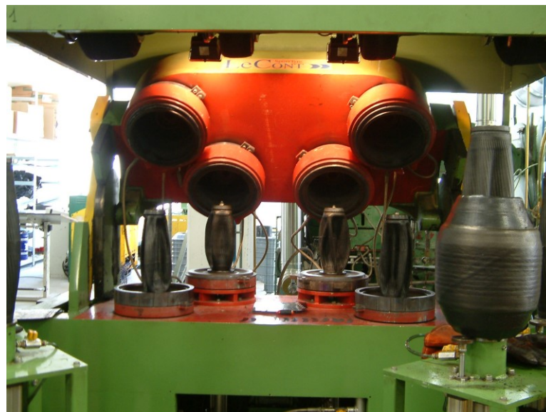
Fig. 1.3 Immagine di una delle presse utilizzate per la vulcanizzazione degli pneumatici.
