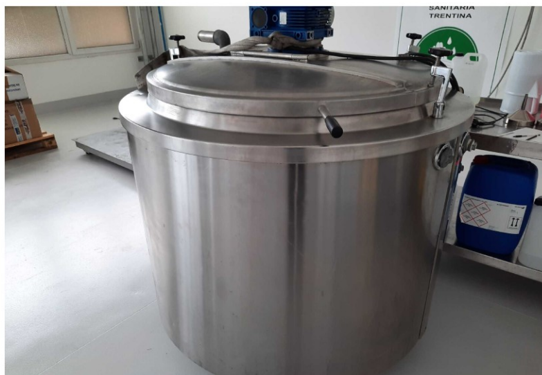
Fig. 5.1. – Immagine del mescolatore del liquido igienizzante.
