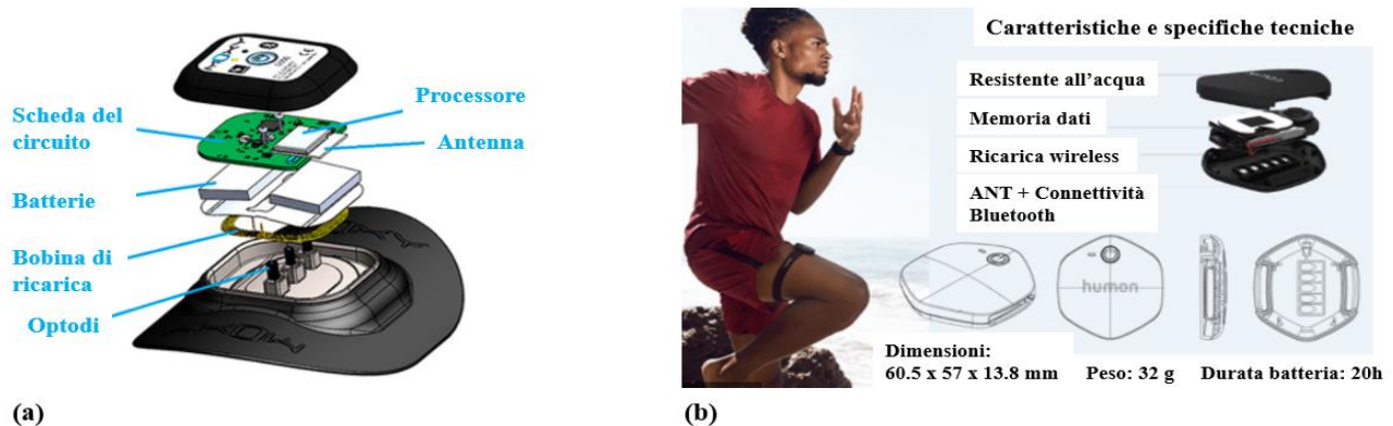
Figura 25. Sensori indossabili per la saturazione dell'ossigeno nei muscoli. (a) Componenti del sensore Moxy Monitor. (b) Caratteristiche del sensore Humon Hex.
