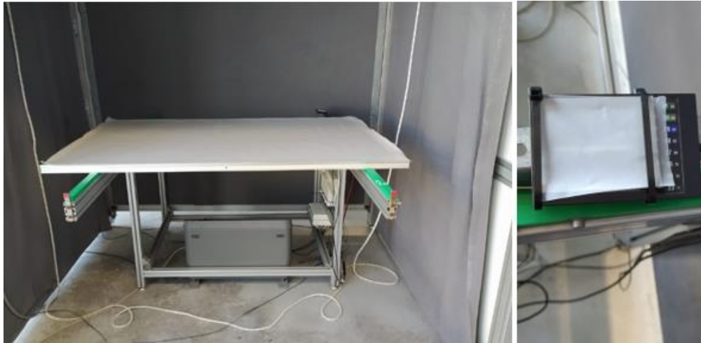
Figura 38 - Rappresentazione banco di prova con il modulo fotovoltaico e cella di riferimento ricoperti con la carta da lucido
