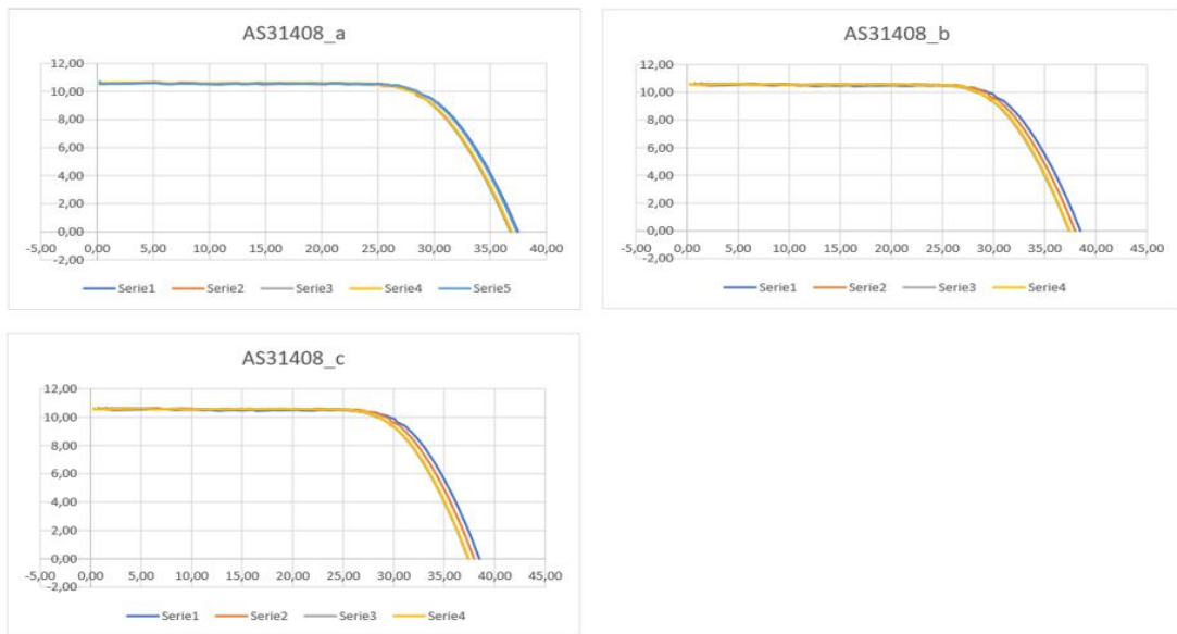
Figura 45- Curve I-V ottenute dai dati sperimentali: a) caratteristiche I-V misurate a diverse temperature dal dispositivo.; b) caratteristica I-V corrette in temperatura con k' = 0 \text{ ohm/K} ; c) caratteristiche I-V con k' = \text{ottimale} .
