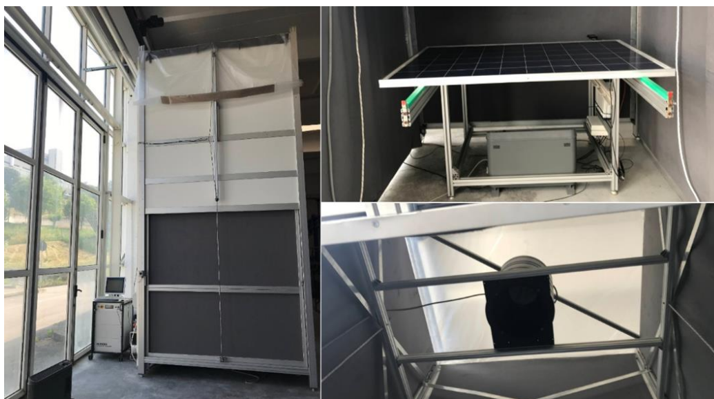
Figura 33 - Torre verticale dove viene emesso il flash contro il modulo FV.
