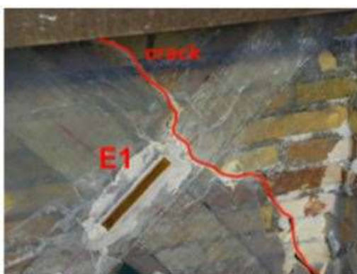
Figura 4.7 Guasto dovuto al distacco della striscia di GFRP
