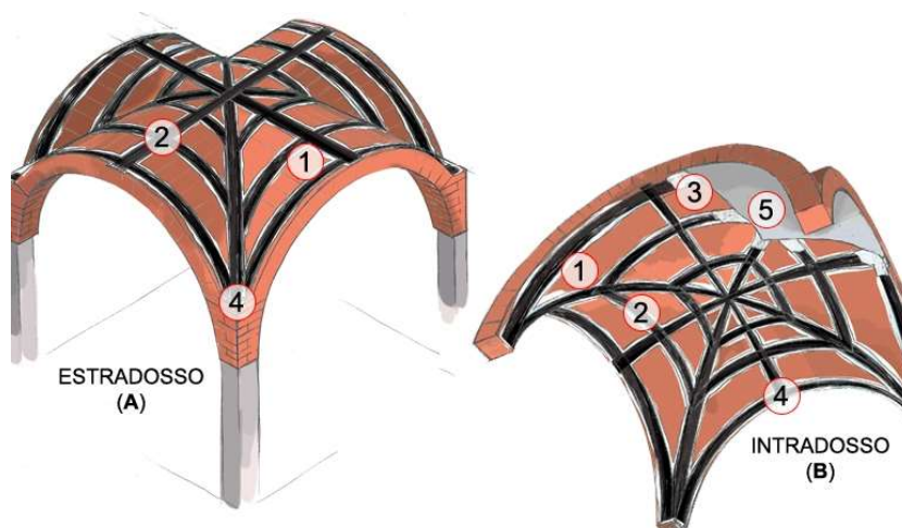
Figura 2.4 – Intervento di rinforzo con FRP (Fonte Internet)
