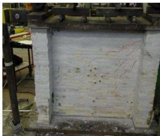
Figura 4.8 Distribuzione delle fessurazioni dopo il ciclo di carico n° 11 per F_{MAX} = 55 KN (R-W2)
