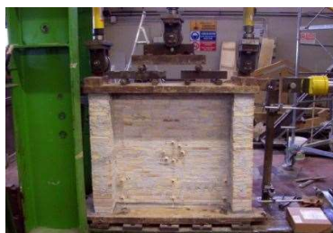
Figura 4.1 - Modellino in scala utilizzato per le prove di laboratorio – Configurazione della parete U-W1 non rinforzata
