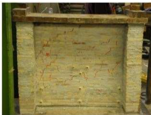
Figura 4.6- Rottura pannello murario non rinforzato
