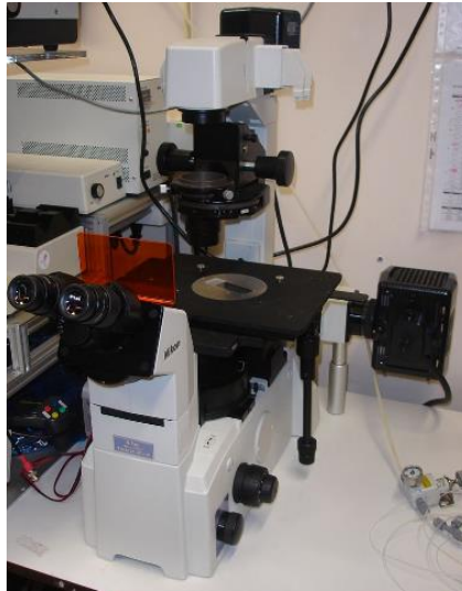
Figura 14. Microscopio rovesciato con il quale si eseguiva l'osservazione delle cellule tenute in coltura.
