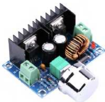
Figura 2.10: Trasformatore DC-DC WINGONEER XL4016E1 (19 V channel)
