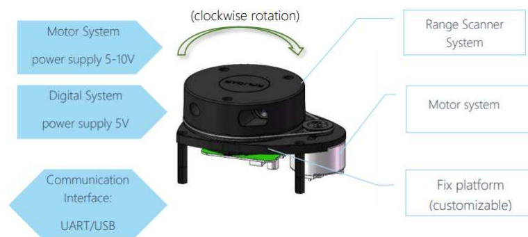
Figura 5.1: Funzionamento RPLIDAR A1
