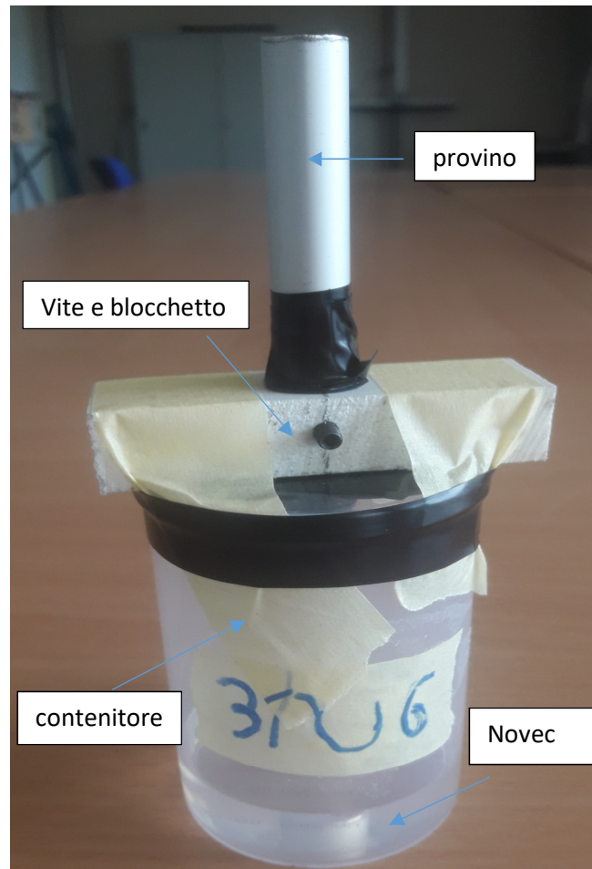
Figura 6.8: provino in alluminio a bagno nel Novec 7000
