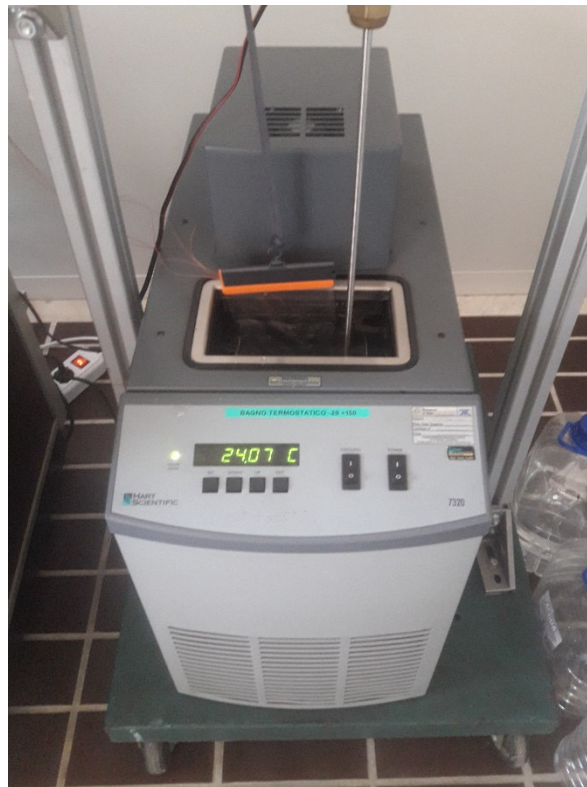
Figura 3.5: bagno termostatico con inserite termocoppie su batteria e termoresistenza
