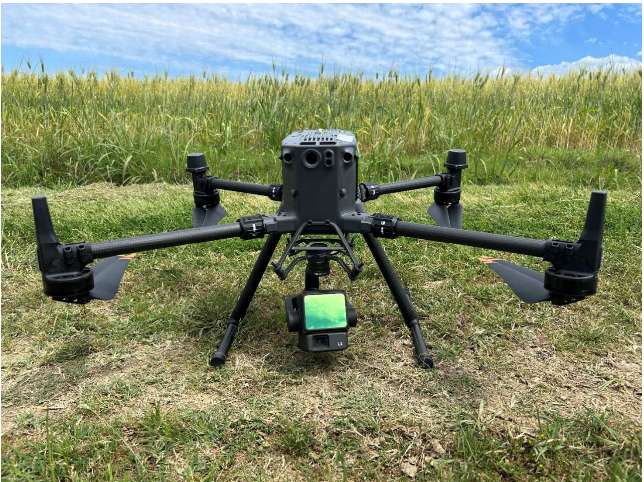
Figura 28 – Drone equipaggiato con camera LiDAR
