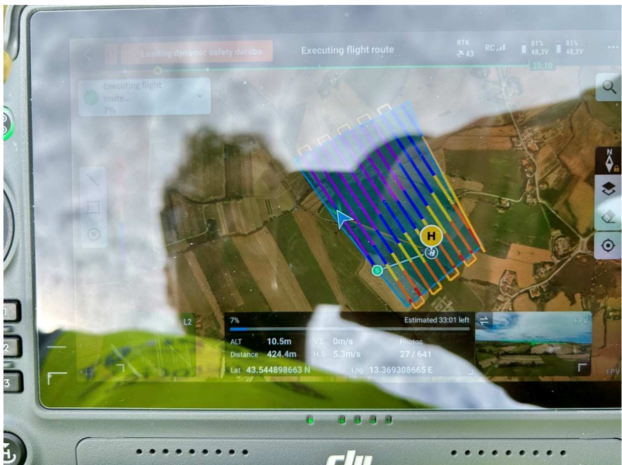
Figura 35 – Posizione e traiettoria del drone in volo durante la raccolta dati
