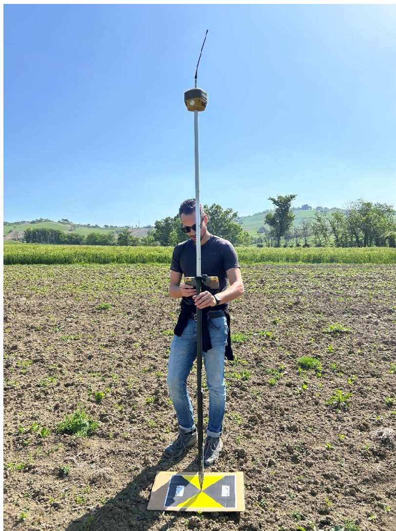
Figura 27 – Antenna GNSS Topcon Hiper equipaggiata con palina telescopica e tablet
