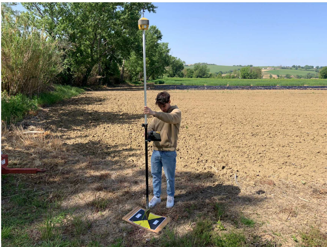
Figura 31 – Misurazione delle coordinate dei Punti di controllo a terra
