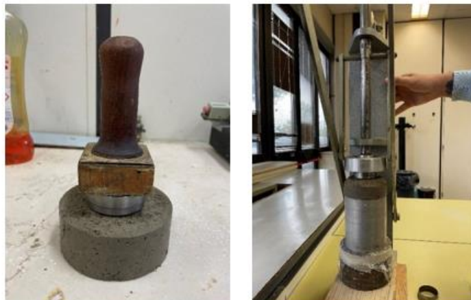
[Fig.43 - Esecuzione del trimming manuale e mediante pressa]
