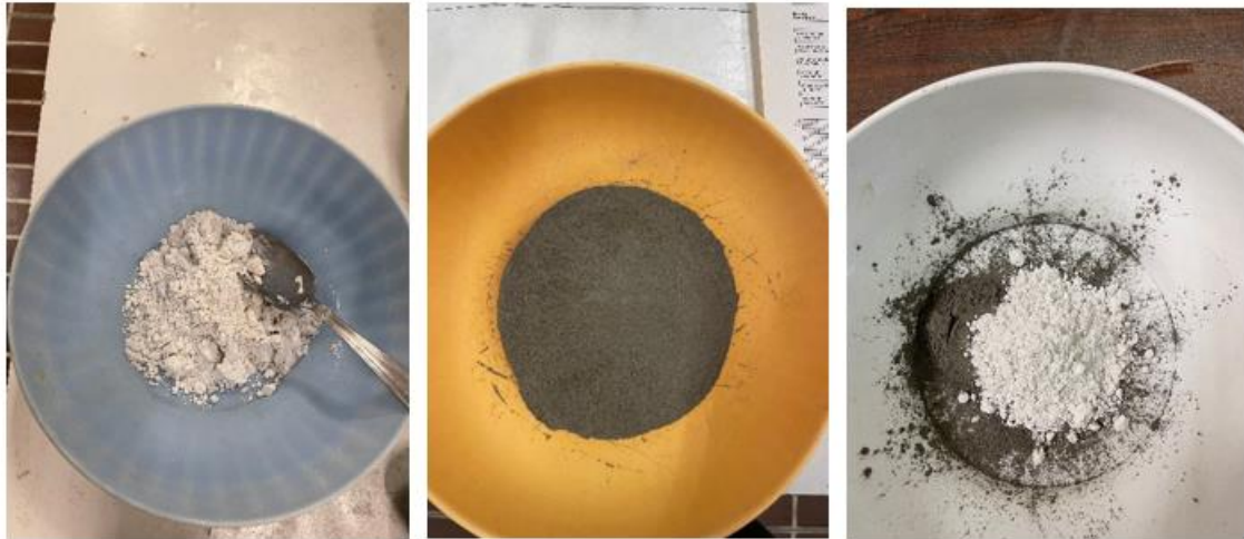
[Fig. 25 - Leganti utilizzati: a sx calce viva ( CaO ), al centro cenere volante ( FA ) e a dx CaO+FA .]
