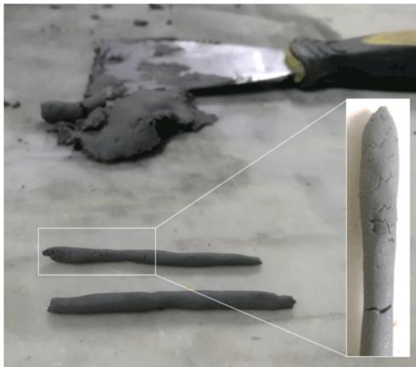
[Fig. 17 – Dettaglio fessura lungo il bastoncino]
