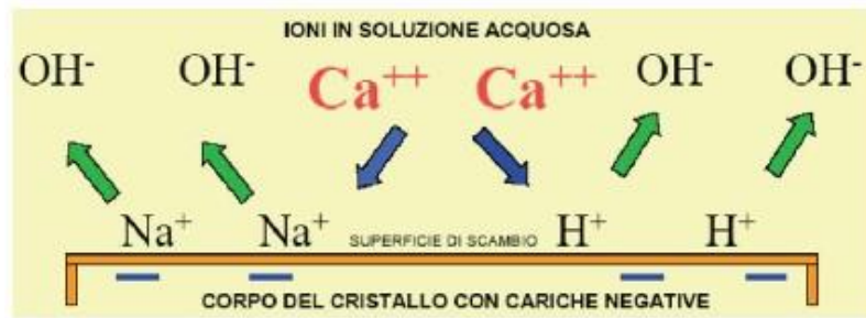
[Fig.4 - Scambio cationico tra gli ioni Ca ++ e quelli naturali del minerale argilloso.]
