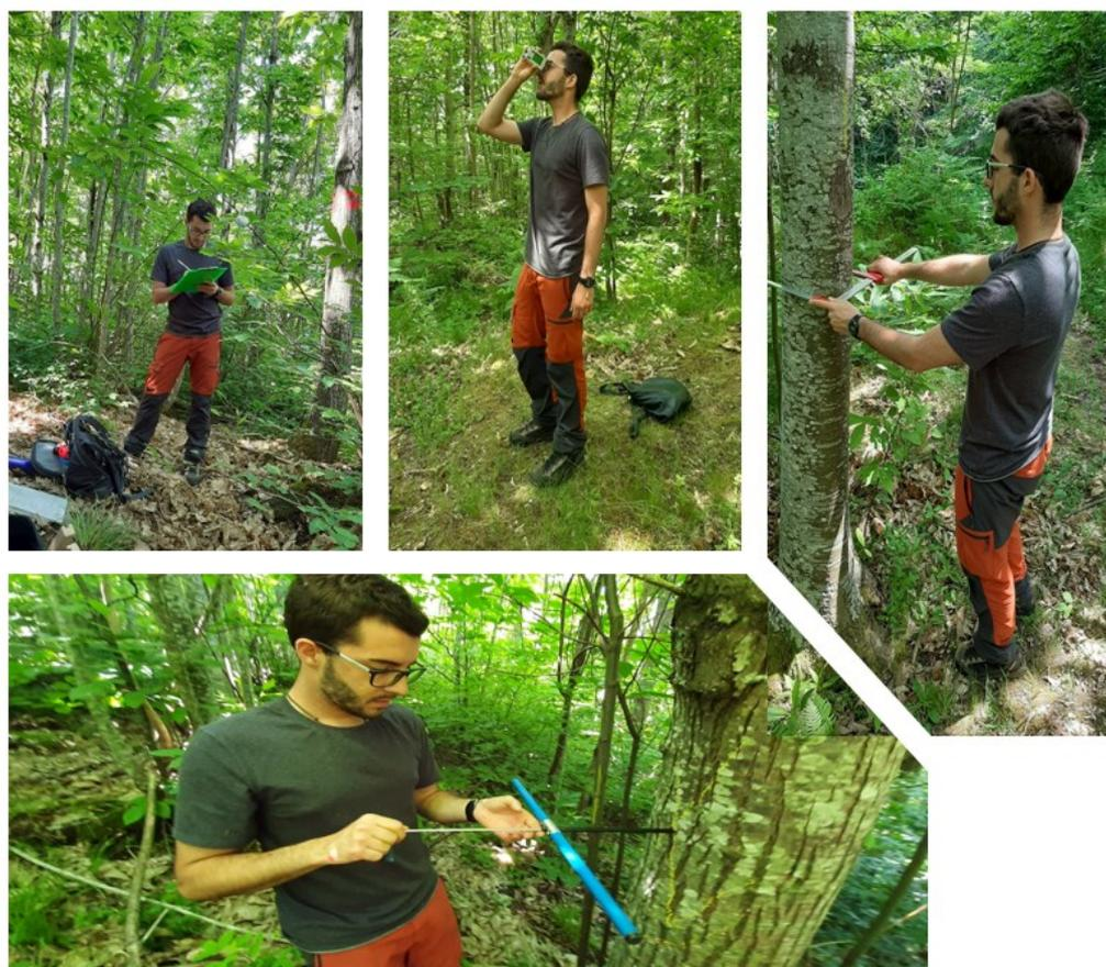
Figura 33 Foto realizzate durante i rilevamenti in campo: a) Compilazione delle schede A e B1 del progetto bosco gestione sostenibile; b) Misurazione altezza con Vertex IV 360 KIT BT; c) Misurazione diametro con cavalletto dendrometrico; d) Carotaggio con trivella di Pressler.
