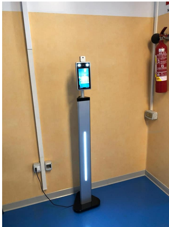
Figura 10:Termoscanner del Reparto di Radioterapia di Ancona
