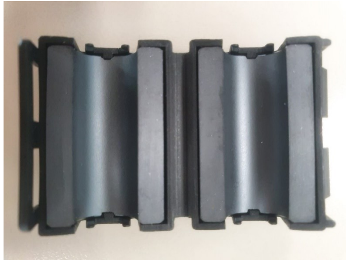
Figura 8-23: ciocch di ferrite per disturbi di modo comune
