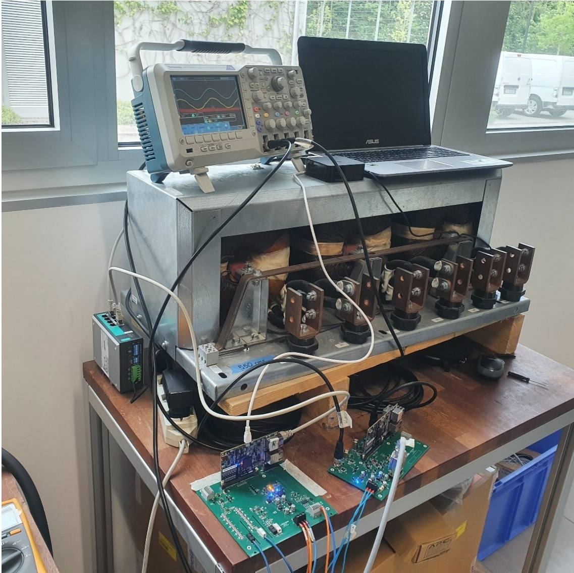
Figura 8-1: set-up di misura per acquisizione su Generic inverter Luccioni
