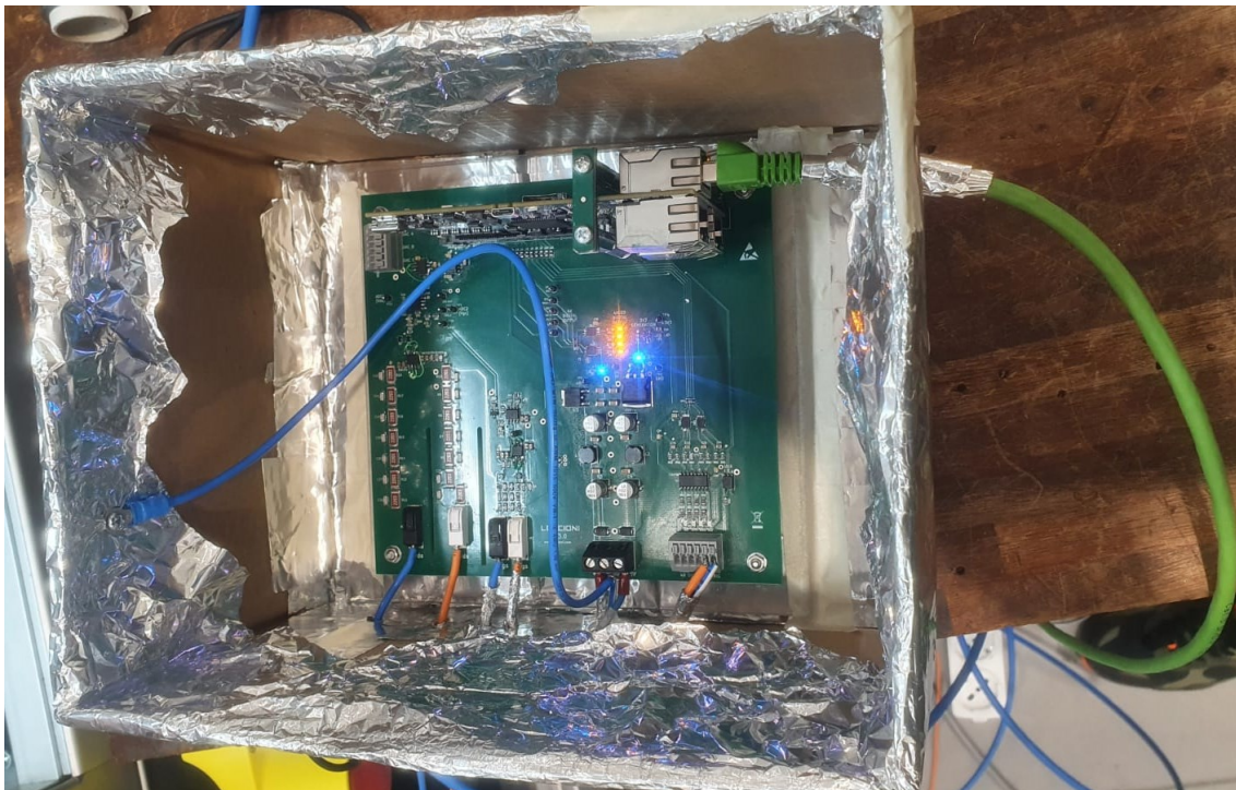
Figura 8-19: schermatura del sistema d'acquisizione
