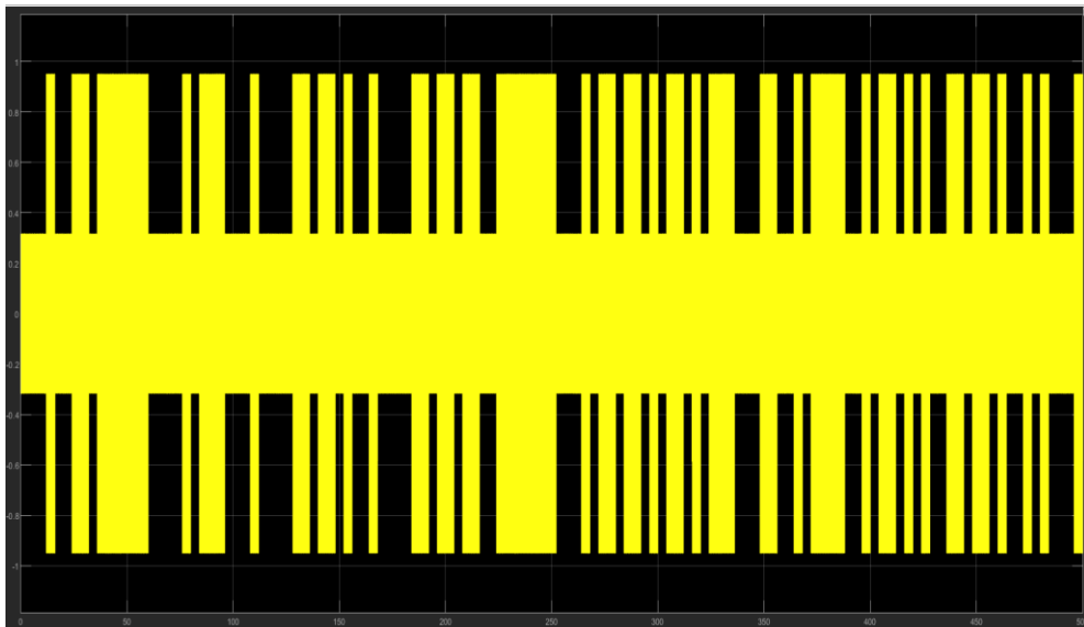
Figura 20. Prodotto tra la parte immaginaria del segnale modulato 16-QAM ed il seno nel tempo ed in frequenza.
