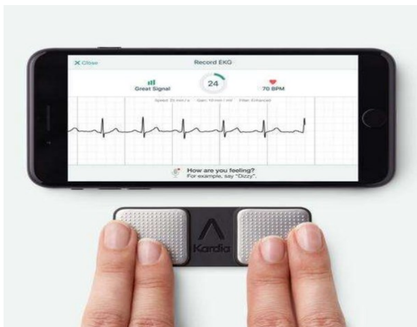
Figura 10: in alto è presente la schermata di acquisizione di un tracciato ECG realizzata con il dispositivo Kardia (in basso)
