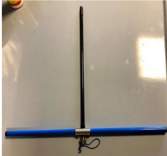
Figura 2.2.2 – Succhiello di Pressler utilizzato per i campionamenti di tasso.
