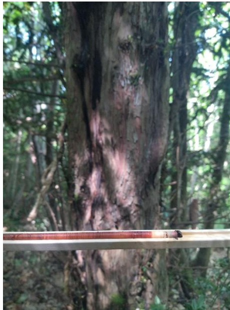
Figura 2.2.1 – Campione legnoso di Taxus baccata prelevato con trivella di Pressler, in corrispondenza dell'individuo censito, appartenente alla popolazione MDT.
