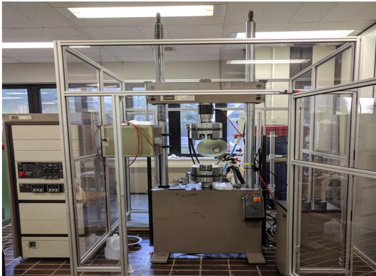
Figura 28 Macchina per prova a trazione
