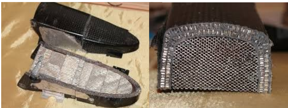
Figura 19 Esempio applicativo di sandwich con core a nido d'ape metallico per musetto anteriore monoposto F1
