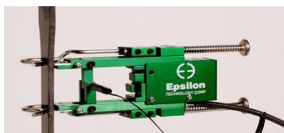
Figura 29 Modalità di applicazione dell'estensimetro
