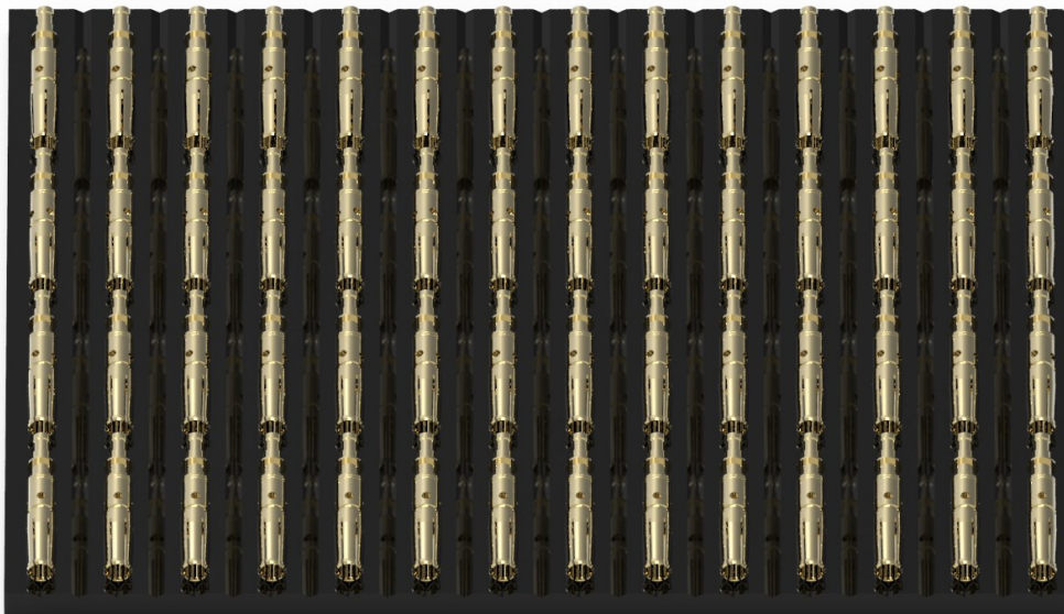
Figura 3-17 Pianale per il posaggio dei pezzi
