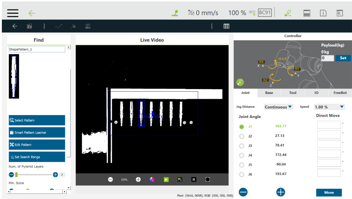
Figura 6-13 Sogliatura dell'immagine e definizione del pattern di riferimento
