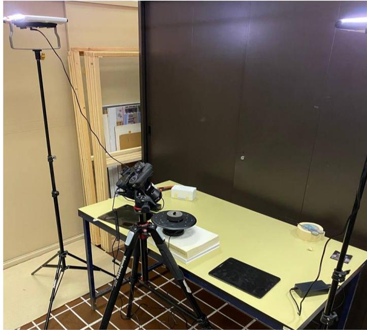
*Figura 3-5: Allestimento set d'acquisizione immagine senza softbox e con le luci LED direzionate verso l'alto*
