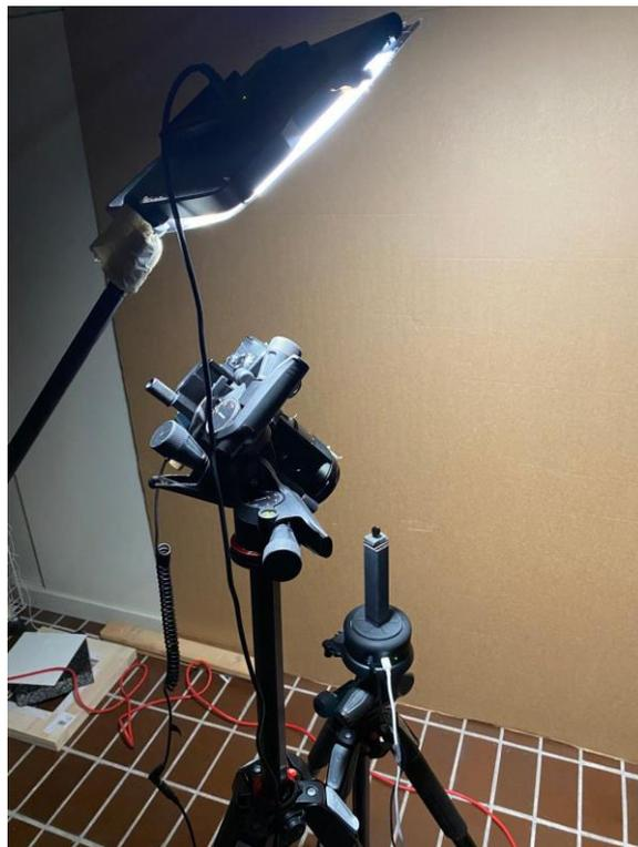
***Figura 3-8: Disposizione della macchina fotografica inclinata a  $45^\circ$  al fine di catturare l'immagine fuori dal box nero***
