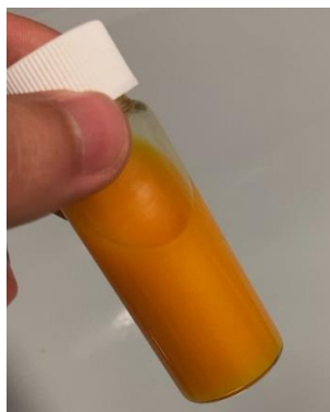
Fig. 3.1: Aspetto della soluzione acquosa di FA prima della variazione di pH.
