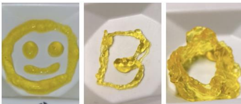
Fig. 3.20: Gel FA-ZnSO 4 iniettato tramite l'utilizzo di una siringa Hamilton.
