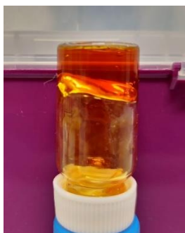
Fig. 3.6: Aspetto dello ionogel di acido folico con liquido ionico (gel FA/LI).
