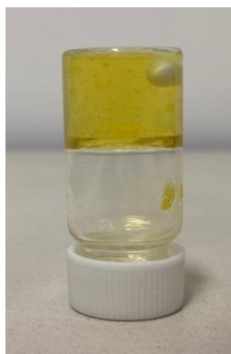
Fig. 3.3: Aspetto del gel FA- ZnSO_4 dopo 24 h.
