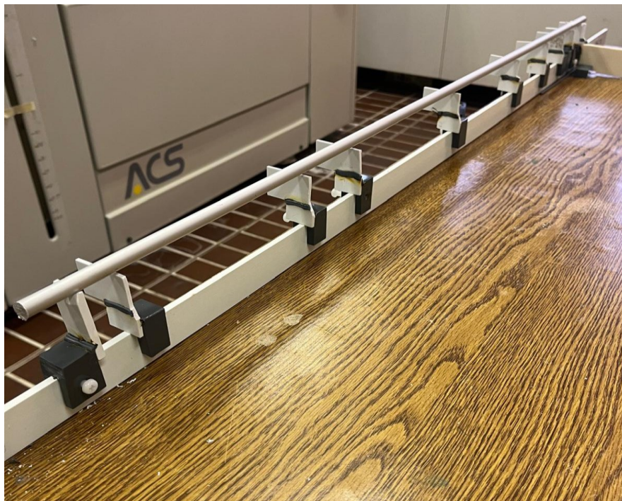
Figura 3.1: guida, supporti per la barra e sonde in PVC
