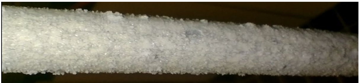
Figura 4.4: L'immagine mostra la barra, ricoperta dello strato di calcare
