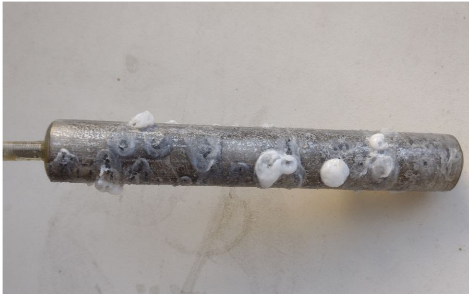
Figura 4.6: L'immagine mostra l'anodo di alluminio dopo le misure
