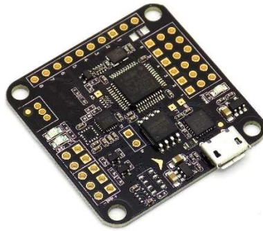
Figura 10 USAQ Naze32 Flight Controller
