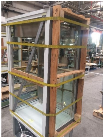
Figura 3.28 – A partire dalla figura in alto a sinistra: vetrina con collante cosparso lungo il telaio PVC, vetrina con primo vetro inserito, vetrina con maschere e cinghie serrate e nastro a tapparelle con vetrine ad asciugare in basso
