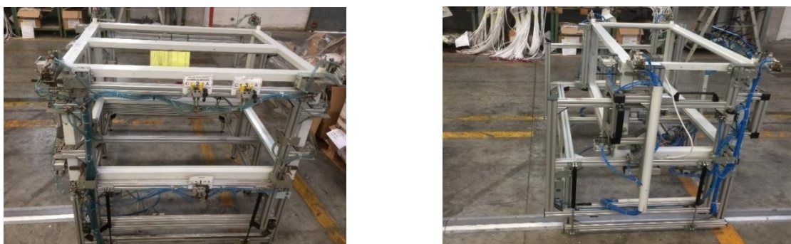
Figura 3.25 – Telai in PVC in attesa che la colla polimerizzi: la struttura in alluminio agisce sul telaio serrandolo a dei battenti grazie ad un sistema pneumatico
