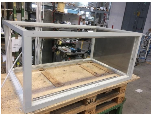
Figura 3.27 – Vetrina nella macro-fase 2. A sinistra nel primo banco di lavoro e a destra in attesa della fase 3 (incollaggio vetri). La vetrina nelle due figure è una KP8Q, la cui caratteristica è di avere l'evaporatore in fondo, nel vano vasca
