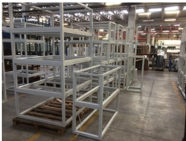
Figura 3.26 – Buffer per stoccaggio telaio: questo polmone garantisce la costante presenza di telai che per essere mandati alla fase successiva del ciclo di lavorazione devono almeno riposare per 5 giorni
