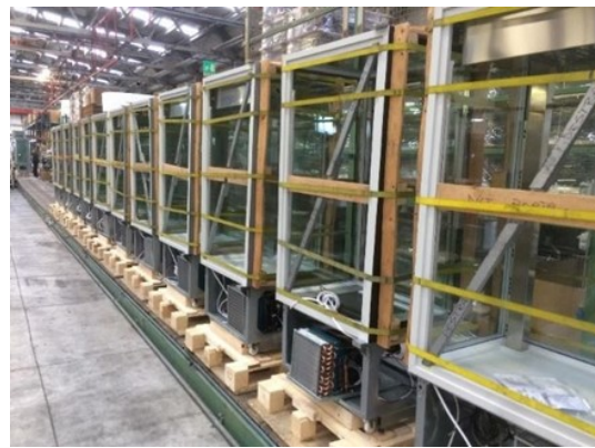
Figura 3.28 – A partire dalla figura in alto a sinistra: vetrina con collante cosparso lungo il telaio PVC, vetrina con primo vetro inserito, vetrina con maschere e cinghie serrate e nastro a tapparelle con vetrine ad asciugare in basso
