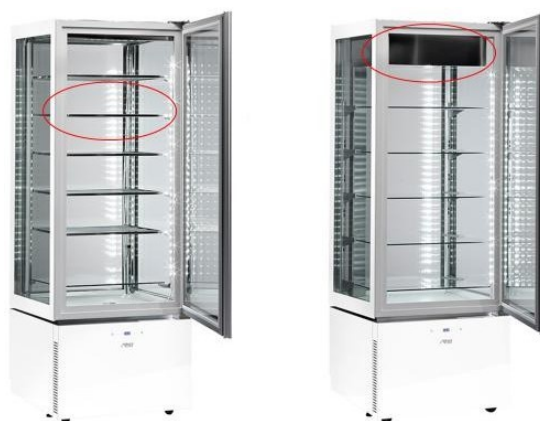
Figura 3.13 – Vetrine BT 600 G sulla sinistra: in rosso una delle griglie per la refrigerazione statica che funge anche da supporto per gli alimenti. A destra una vetrina BT 600 D con evidenziato l'aereo- evaporatore in alto; i ripiani visibili nella vetrina D sono in vetro
