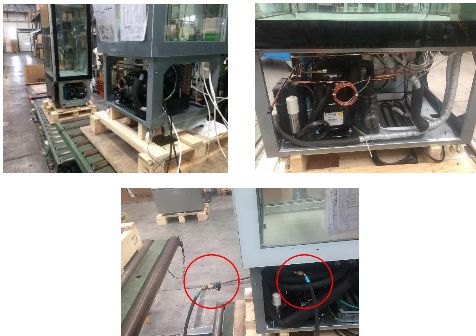
Figura 3.30 – Vetrina pronta per il cablaggio in alto a sinistra, con chiusura circuito termodinamico effettuata con saldatura ossiacetilenica in alto a destra e in fase di vuoto e carica in basso al centro. Nell'ultima immagine sono evidenziati gli spinotti di collegamento della macchina di carico del fluido refrigerante ai terminali aperti del circuito termodinamico
